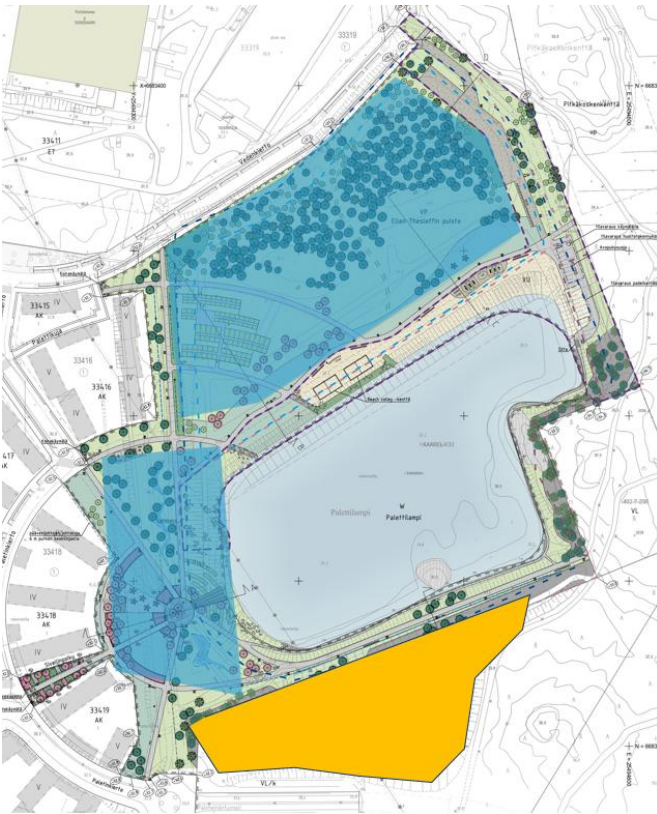
Ylijäämämaat ja kaivumaat sekä tunnelilouhe esikuormituspenerkeessä.
