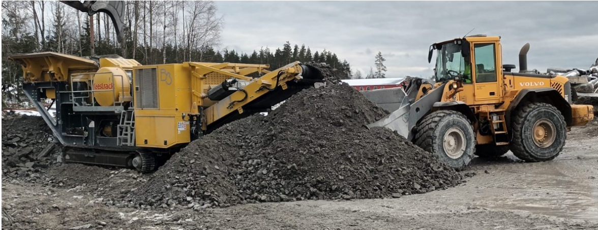
Kuva 11. Valmiin betonimurskeen kuljettaminen kasalle pyöräkuormaajalla
