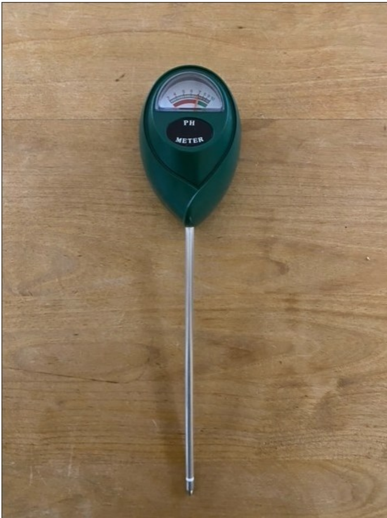
Kuva 17. Mittauslaite, jonka mittausvyvyys noin 300 millimetriä
