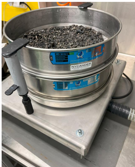
Kuva 10. Kokeessa käytetty pesuseulontalaitteisto.
