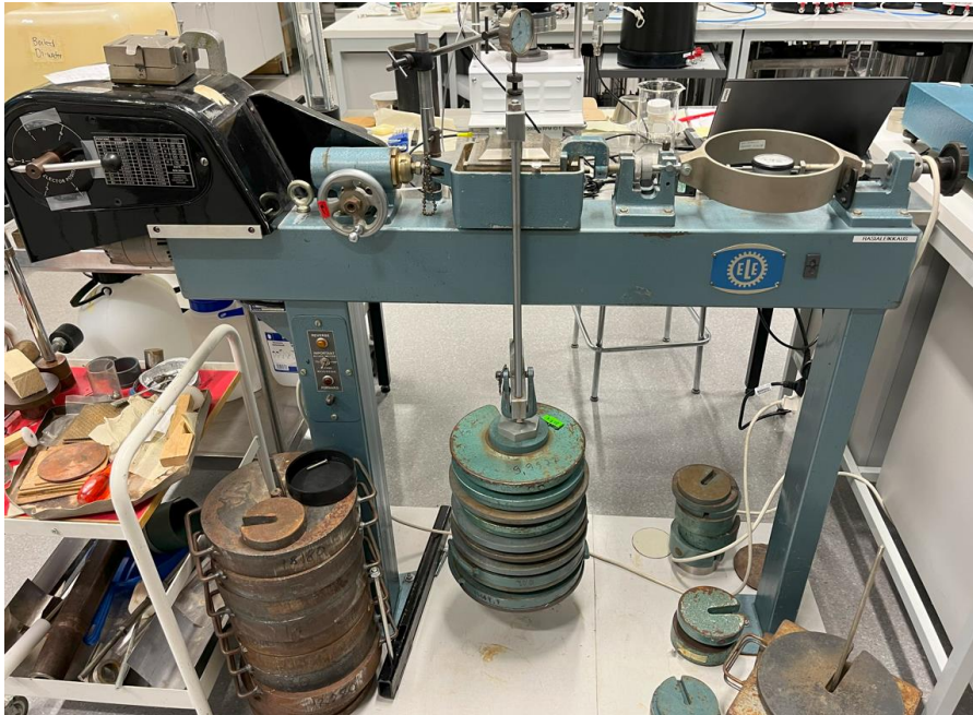
Kuva 16. Kokeessa käytetty rasialeikkauslaitteisto.
