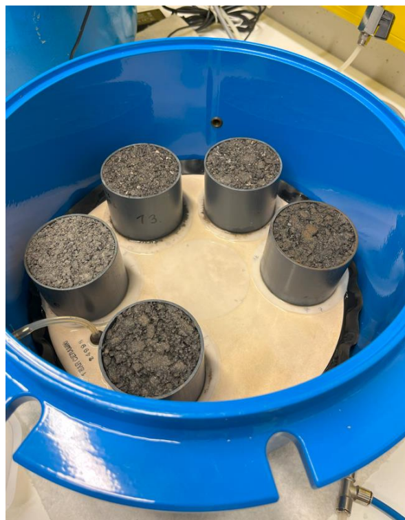
Kuva 20. PF-kokeessa käytetty paineastia. Vesi poistuu näytteistä ja imulevystä kuvassa näkyvän muoviputken kautta.
