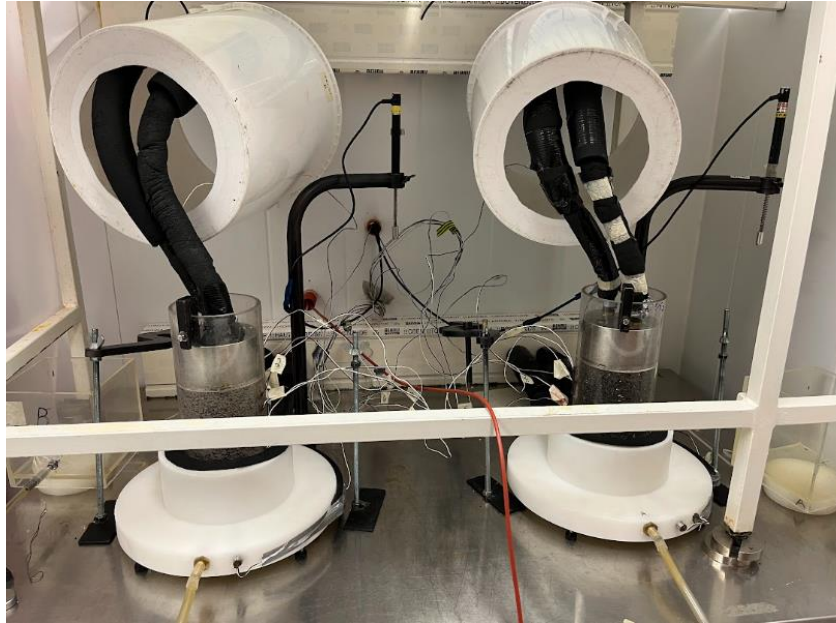
Kuva 23. Masuunikuona ja EAF-kuona tiivistettynä routalaitteistoon.
