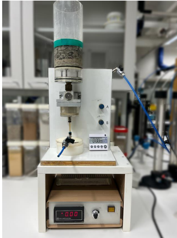
Kuva 15. Kapillaarisen nousukorkeuden määrittämiseen käytetty Sahi-kapillaarimetri.
