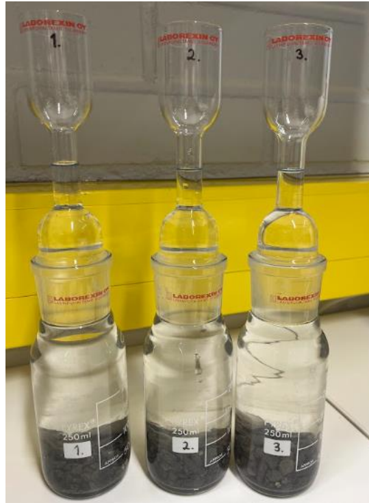
Kuva 22. Kiintotiheyden määrittämiseen käytetyt pyknometrit.
