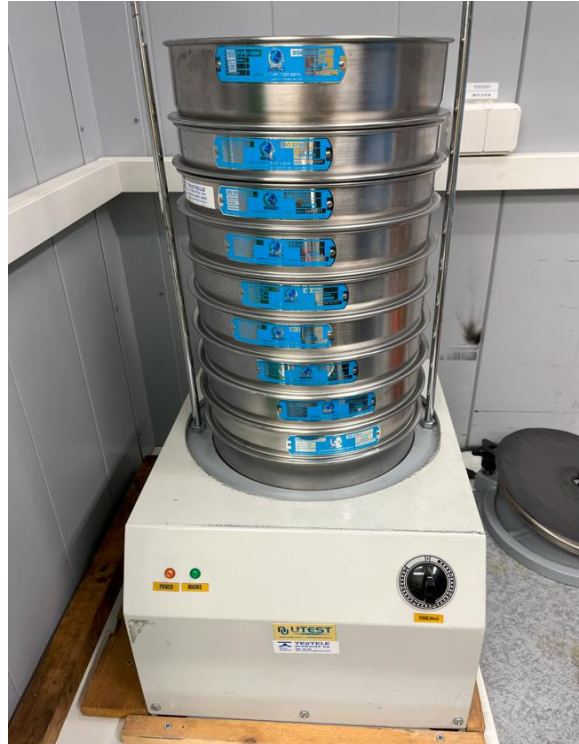
Kuva 11. Kokeessa käytetty kuivaseulontalaitteisto.
