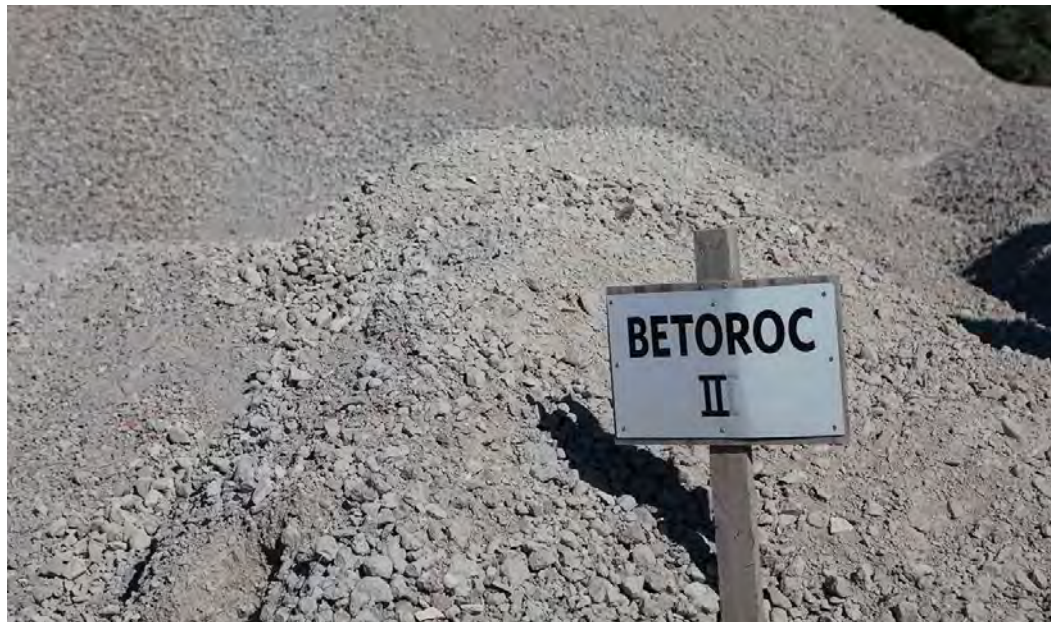
Kuva 3. Rudus Oy:n valmistamaa, BeM II -luokan betonimursketta [14].
