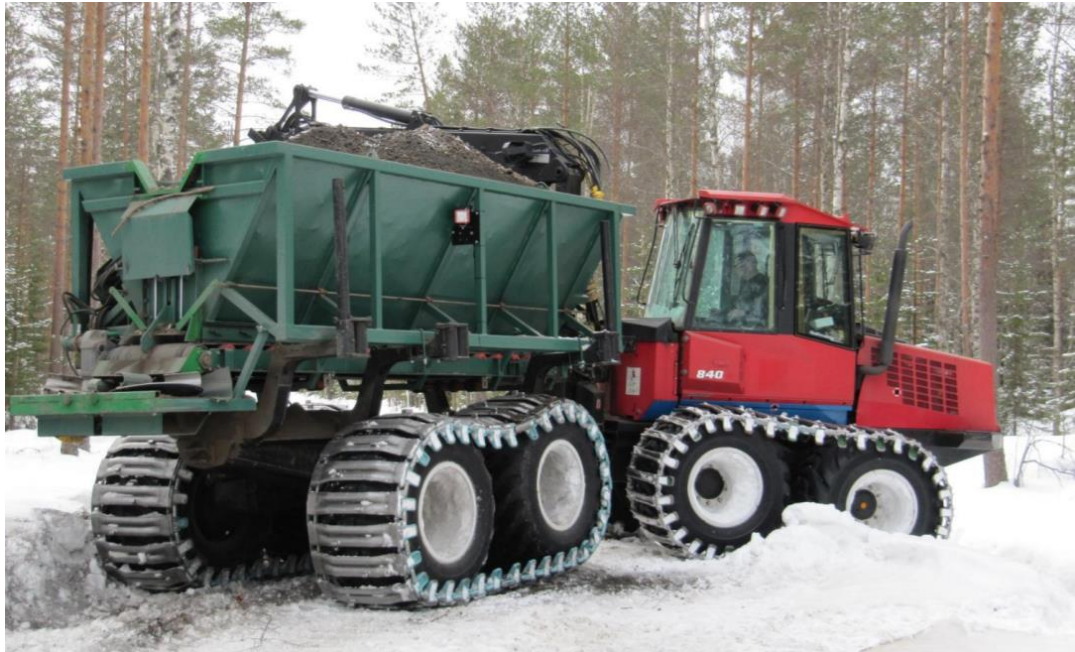
Kuva 3. Maalevitystä kuormatraktorilla (Parviainen 2014)
