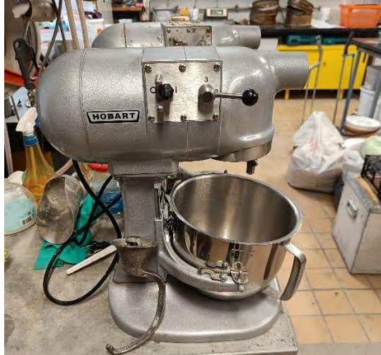
Kuva 6.1: Aalto-yliopiston laboratorio. a) Stabiloitavuuskokeissa käytössä oleva Hobart keittiösekoitin. b) Runko ja sideaineen sekoituksessa käytetty sekoitinkoukkumalli. (Ikävalko 2023)
