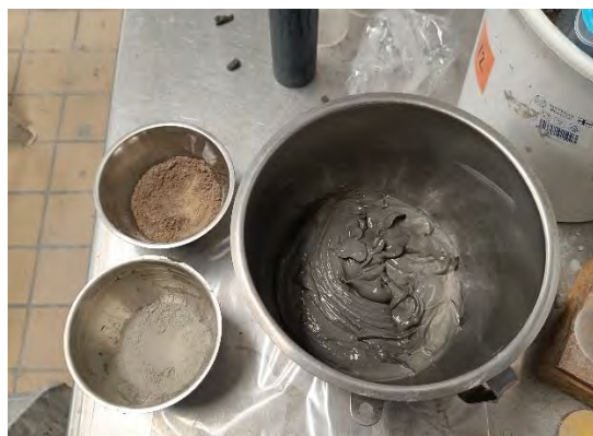
Kuva 6.2: Sideaineet ja savinäyte ennen sekoitusta. Vasemmalla ylemmässä kulhossa on LT KAU lentotuhka ja alemmassa kulhossa CEMII sideaine. Isossa kulhossa on homogenisoitu savinäyte. (Ikävalko 2023)
