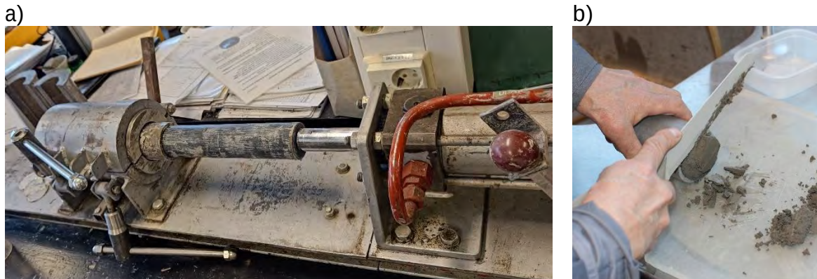
Kuva 6.5: a) Koekappaleen poisto muotista ja b) koekappaleiden määrämittaan leikkaaminen. (Ikävalko 2023)
