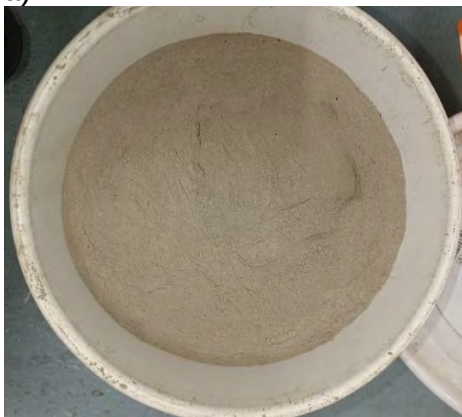
Kuva 5.5: Kuvassa a) UPM Kymmenen Jämsänkosken LT+CEM II 70/30 sideaineseos, sideaine päällisin puolin tasalaatuista. (Ikävalko 2022) b) Kuninkaantammen koestabilointialue. UPM lentotuhkan ja sementin työmaasäiliöt sideaineseosten sekoittamiseen paikan päällä (Nguyen 2021).
