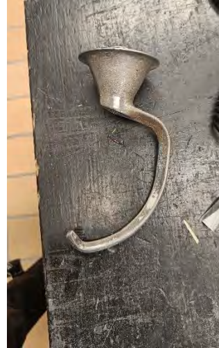
Kuva 6.1: Aalto-yliopiston laboratorio. a) Stabiloitavuuskokeissa käytössä oleva Hobart keittiösekoitin. b) Runko ja sideaineen sekoituksessa käytetty sekoitinkoukkumalli. (Ikävalko 2023)
