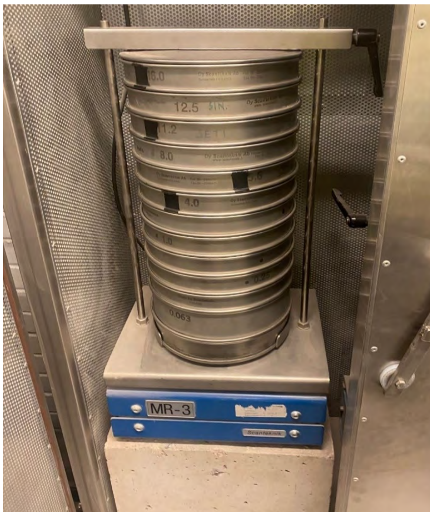
Kuva 10. Rakeisuuden määrittämisessä käytetty tärytinlaite (Ristikankare, 2024).
