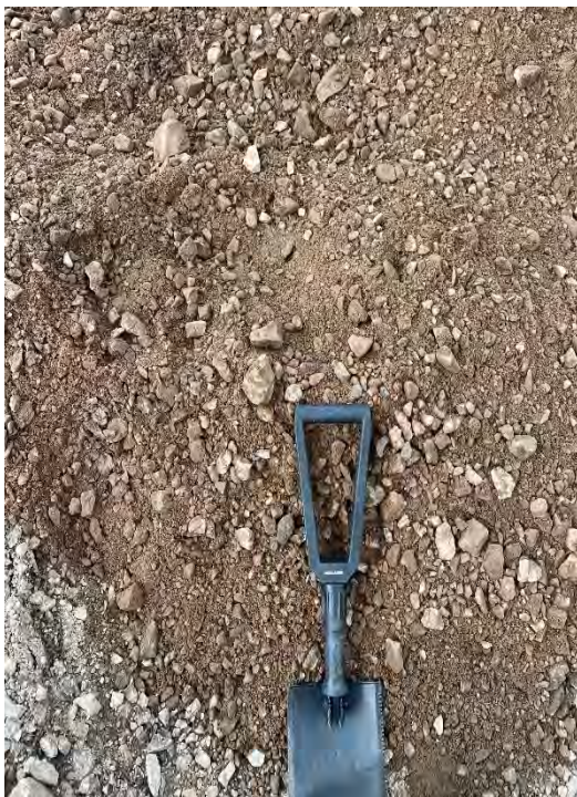
Kuva 21. Vasemmalla kuvassa pisteen 1017 kantavan kerroksen pois kaivettu maa-aines Tattariharjunttiellä ja oikealla kuvassa pisteen 1017 jakavan kerroksen pois kaivettu maa-aines (Ristikankare, 2024).
