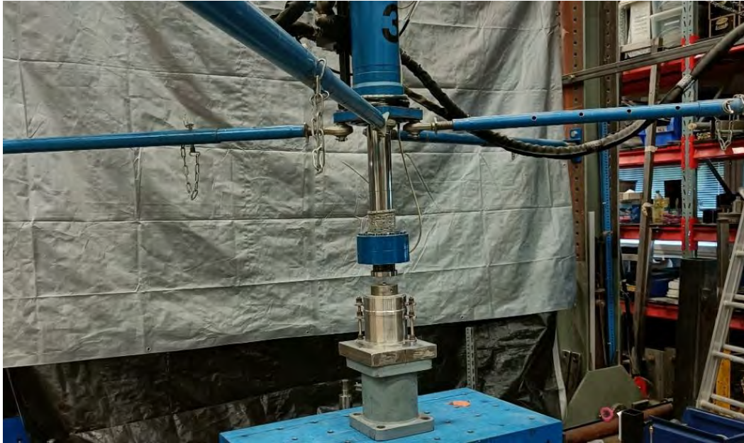
Kuva 30. Kokoonpuristuvuuden ja puristuslujuuden määrittämisessä käytetty laitteisto. (Kuva: Juho Lautala)
