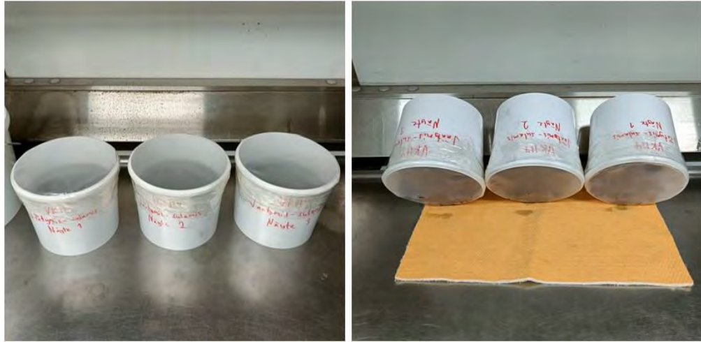
Kuva 27. Jäädytys-sulatuskokeen aikainen testinäytteiden kyllästämisen ja sulatus (vas.) sekä ylimääräisen veden valuttaminen pois (oik.). (Kuva: Juho Lautala)
