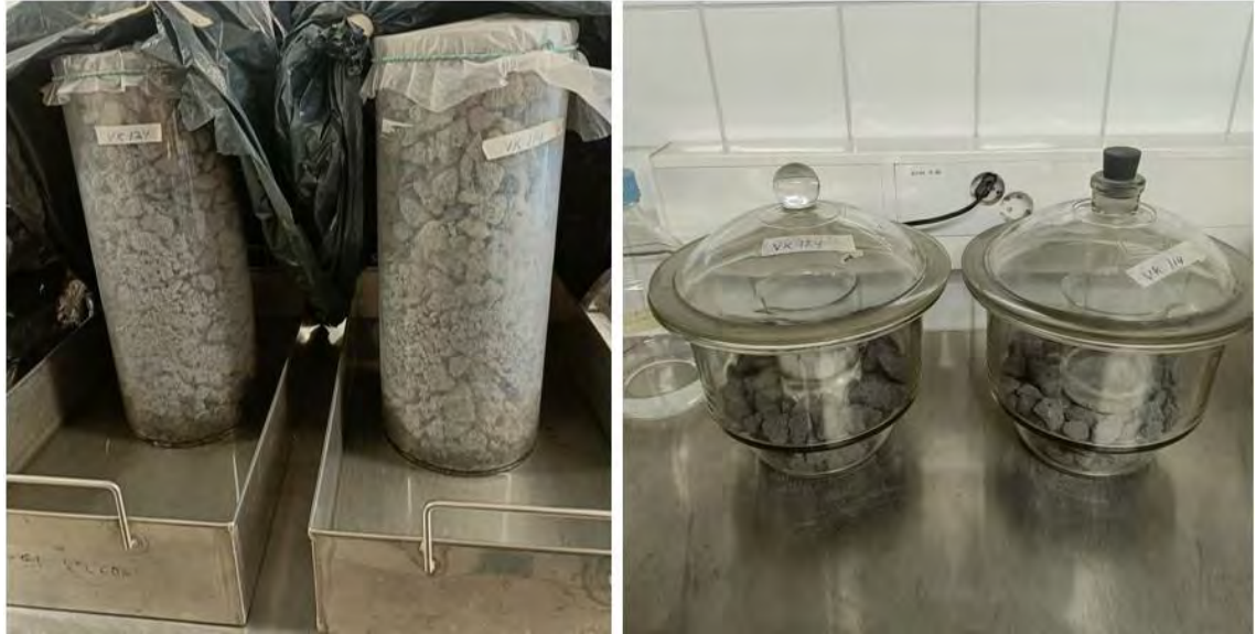
Kuva 24. Vedenimeytymiskorkeuden määrittäminen (vas.) ja siihen liittyvän hygroskooppisen vedenimukykyyn määrittäminen (oik.). (Kuva: Juho Lautala)
