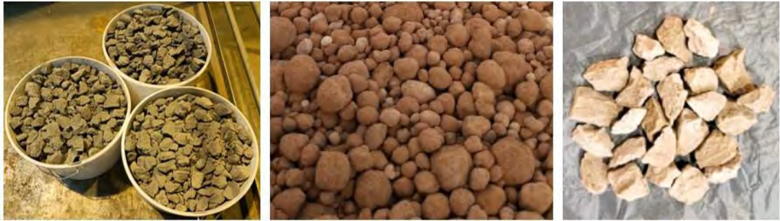
Kuva 8. Sementillä ja sementinkaltaisilla sideaineilla valmistetut kevytkiviainekset, jollaisia ovat esimerkiksi sementtipohjainen vaahtokuonamurske (vas.) (Kuva: Juho Lautala), pozzolaaninen Fill-R-tuhkarae (kesk.) ja geopolymeeripohjainen kevytkiviainesmurske (oik.). (Räisänen, 2015; Xu et al., 2021)
