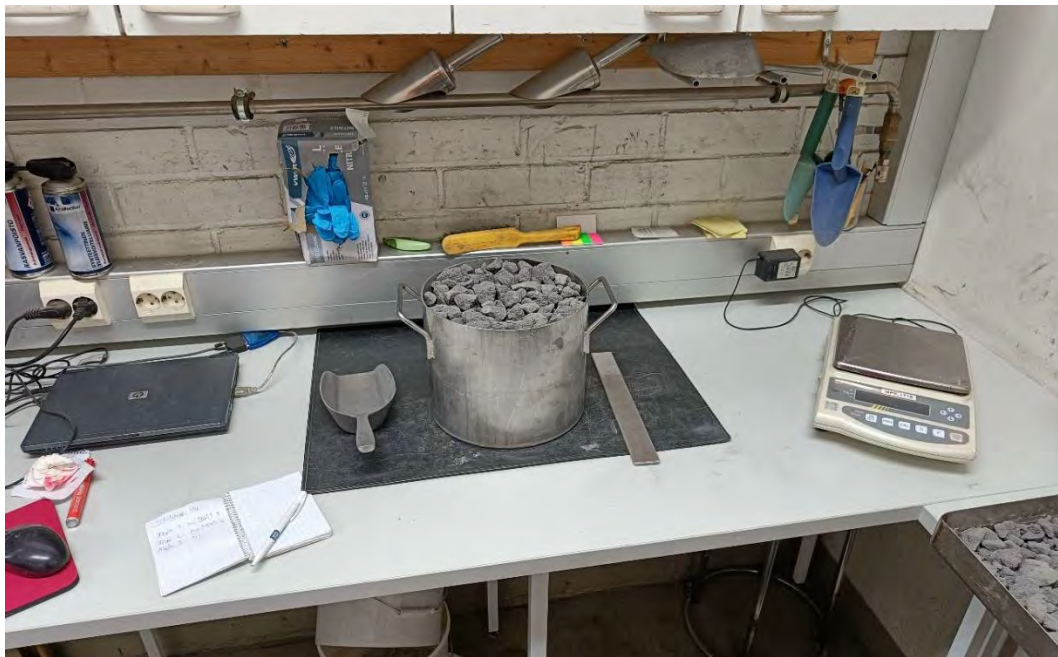
Kuva 17. Kuivairtoteiheyden määrittäksessä käytetyt välineet. (Kuva: Juho Lautala)
