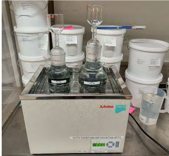
Kuva 23. Kiintotiheyden ja vedenimeytymisen määrittäminen pyknometrillä. (Kuva: Juho Lautala)
