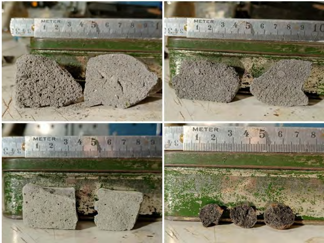
Kuva 20. Halkaistujen rakeiden huokosrakenteesta perinteisellä kameralla otetut kuvat vahtokuonamurske-eristä VK114 (vas. ylä) ja VK124 (oik. ylä) sekä vertailumateriaaleista Foamit-vahtolasimurskeesta (vas. ala) ja Leca-kevytsorasta (oik. ala). Kuvissa näkyvän mitan numeroiden väli on 1 cm. (Kuva: Juho Lautala)
