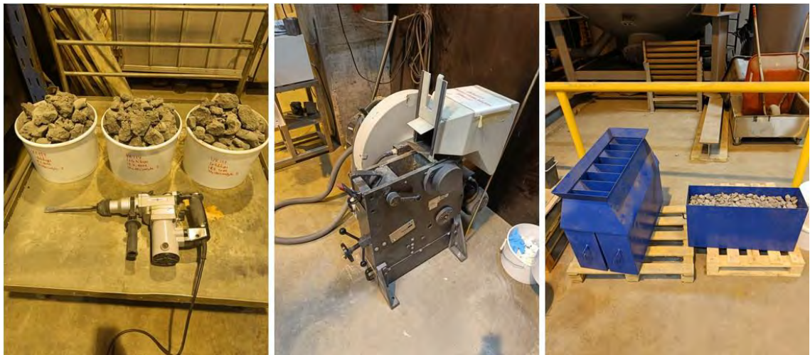
Kuva 16. Vaahtokuonamurskeen valmistuksessa käytetyt välineet: iskuporakone (vas.), leukamurskain (kesk.) ja jakolaatikko (oik.). (Kuva: Juho Lautala)
