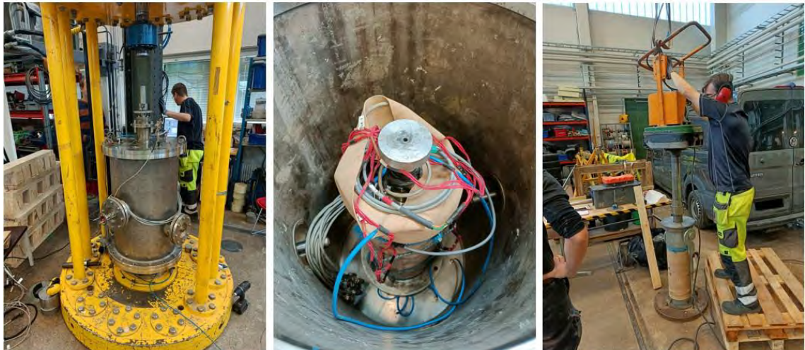
Kuva 29. Kolmiakσιαalikoelaitteisto ja näyteselli (vas.), antureilla varustettu kolmiakσιαalikokeen koekappale näytesellissä (kesk.) ja kolmiakσιαalikokeen koekappaleen tiivistäminen (oik.). (Kuva: Juho Lautala)
