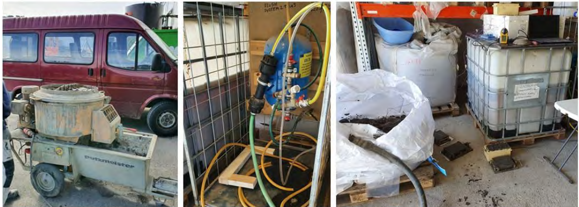
Kuva 14. Vaahtokuonamassan valmistuksessa käytetty sekoitin- (vas.), vaahdotus- (kesk.) ja mittalaitteisto (oik.). (Mäkinen, 2022)
