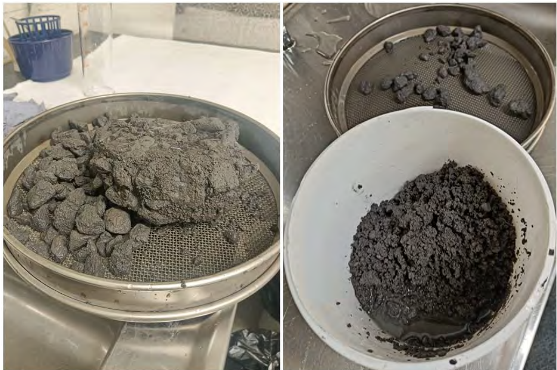
Kuva 28. Vaahtokuonamurske-erän VK124 testinäyte ensimmäisen jäädytys-sulatuskokeen jälkeen (vas.) ja vaahtokuonamurske-erän VK124 testinäyte toisen jäädytys-sulatuskokeen jälkeen (oik.). (Kuva: Juho Lautala)
