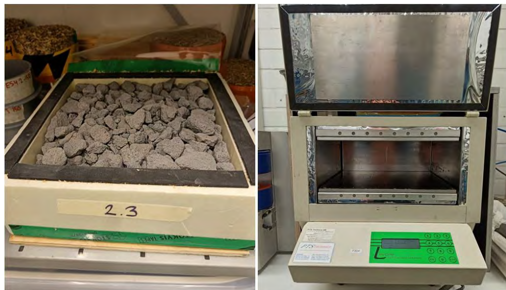
Kuva 26. Lämmönjohtavuusmittausten testinäyte tasapainottumassa kosteuspitoisuuteen (vas.) ja lämmönjohtavuuden mittauksessa käytetty FOX304-mittalaite (oik.). (Kuva: Juho Lautala)
