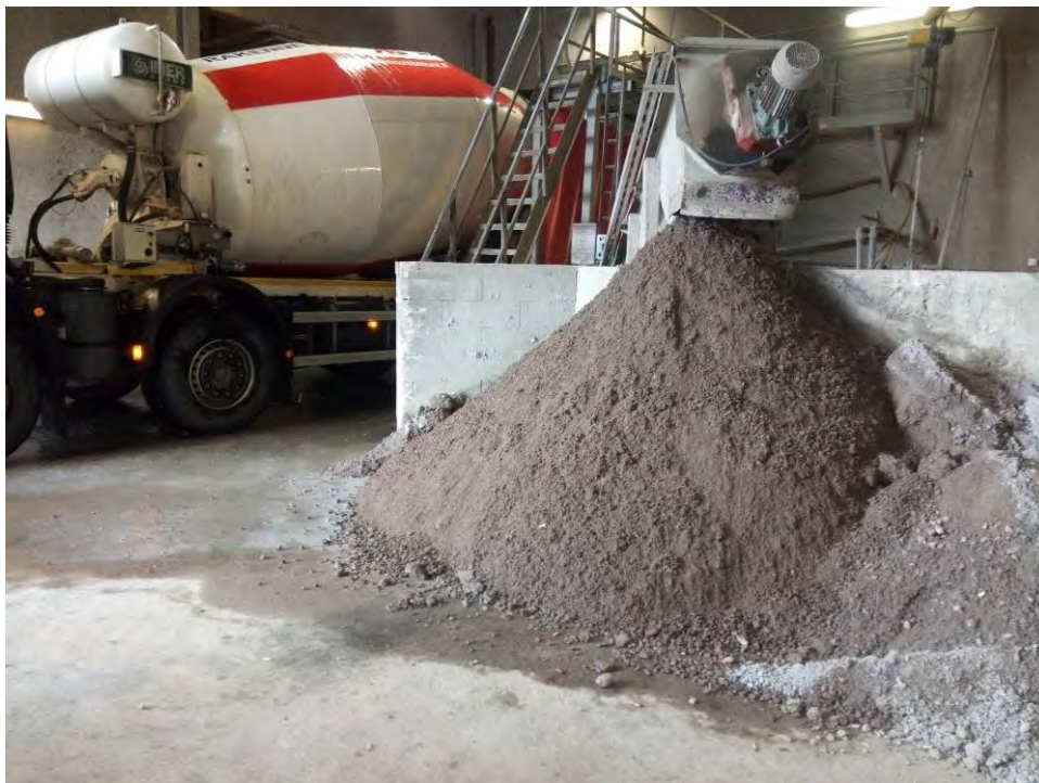
Kuva 11. Ruuvipesuri nostaa karkean kiviaineksen erilleen tuoreesta betonista hallin lattialle
