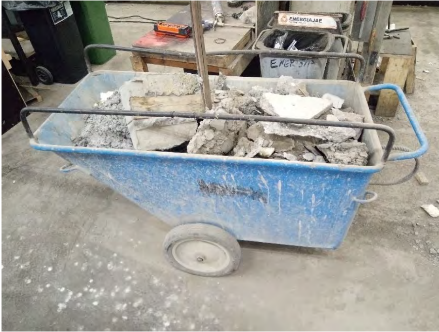
Kuva 3. T-kärry on tilavuudeltaan 420 litraa ja kestää 750 kg kuorman
