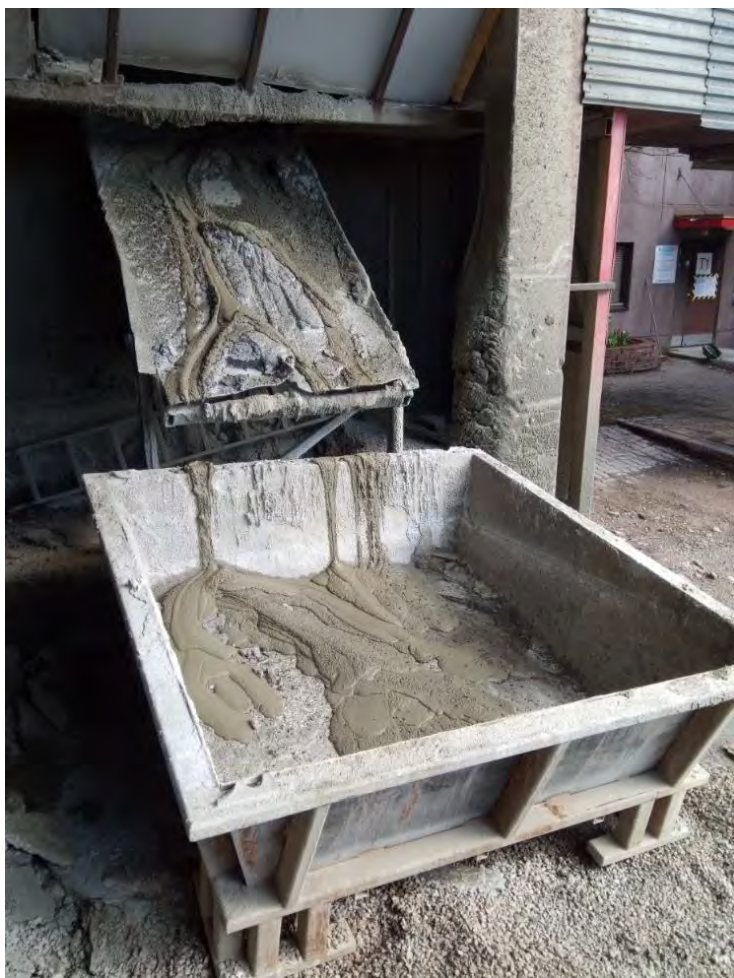
Kuva 7. Myllystä 3 valuneet betonit (ei vielä pesuvettä)
