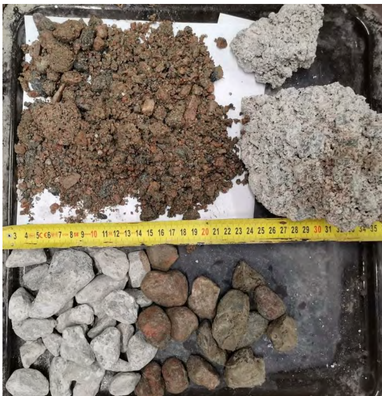
Kuva 23. Betonikiviainespesurin karkeaa kiviainesta ja myllyn 1 pesukiveä
