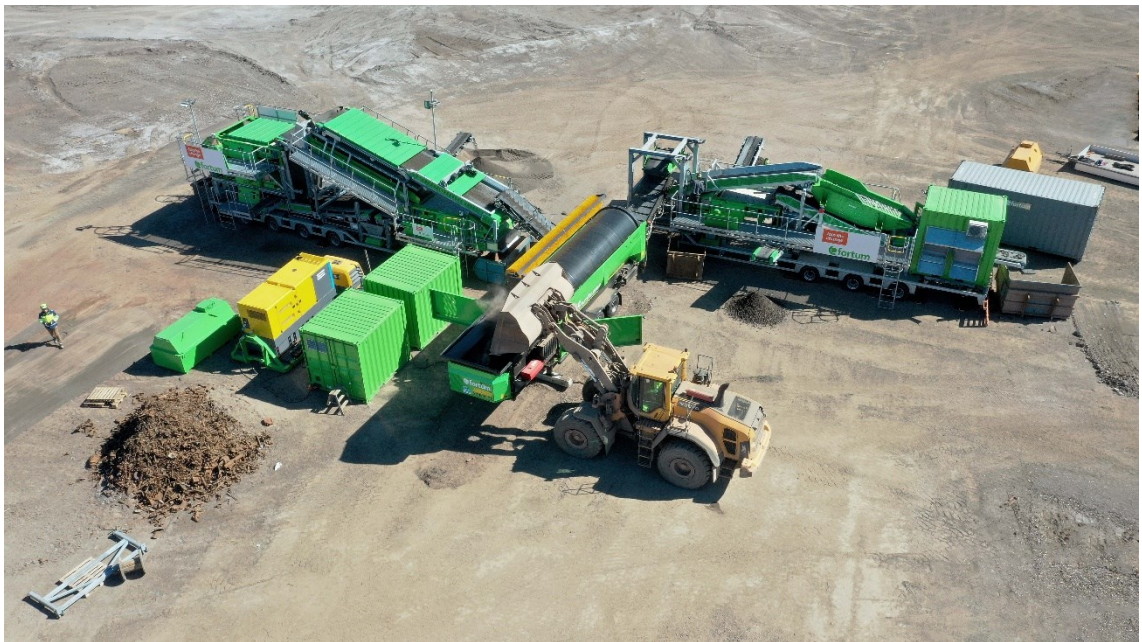
Kuva 4. Kuonan käsittelyä Fortumin Riihimäen laitoksella. (Fortum Waste Solutions Oy)
