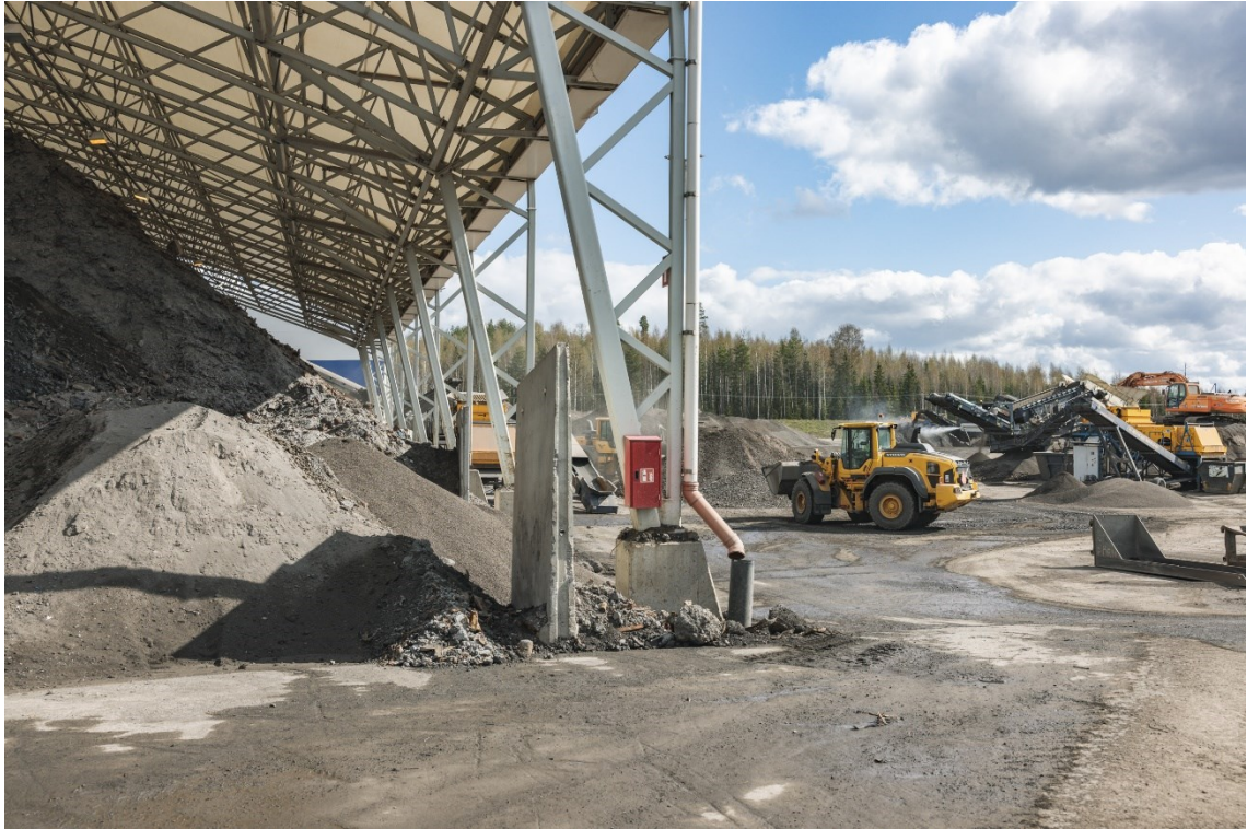
Kuva 3. Pohjakuonaa, josta metalleja ei vielä ole eroteltu, katoksessa Fortumin Riihimäen käsittelykeskuksessa. (Fortum Waste Solutions Oy)
