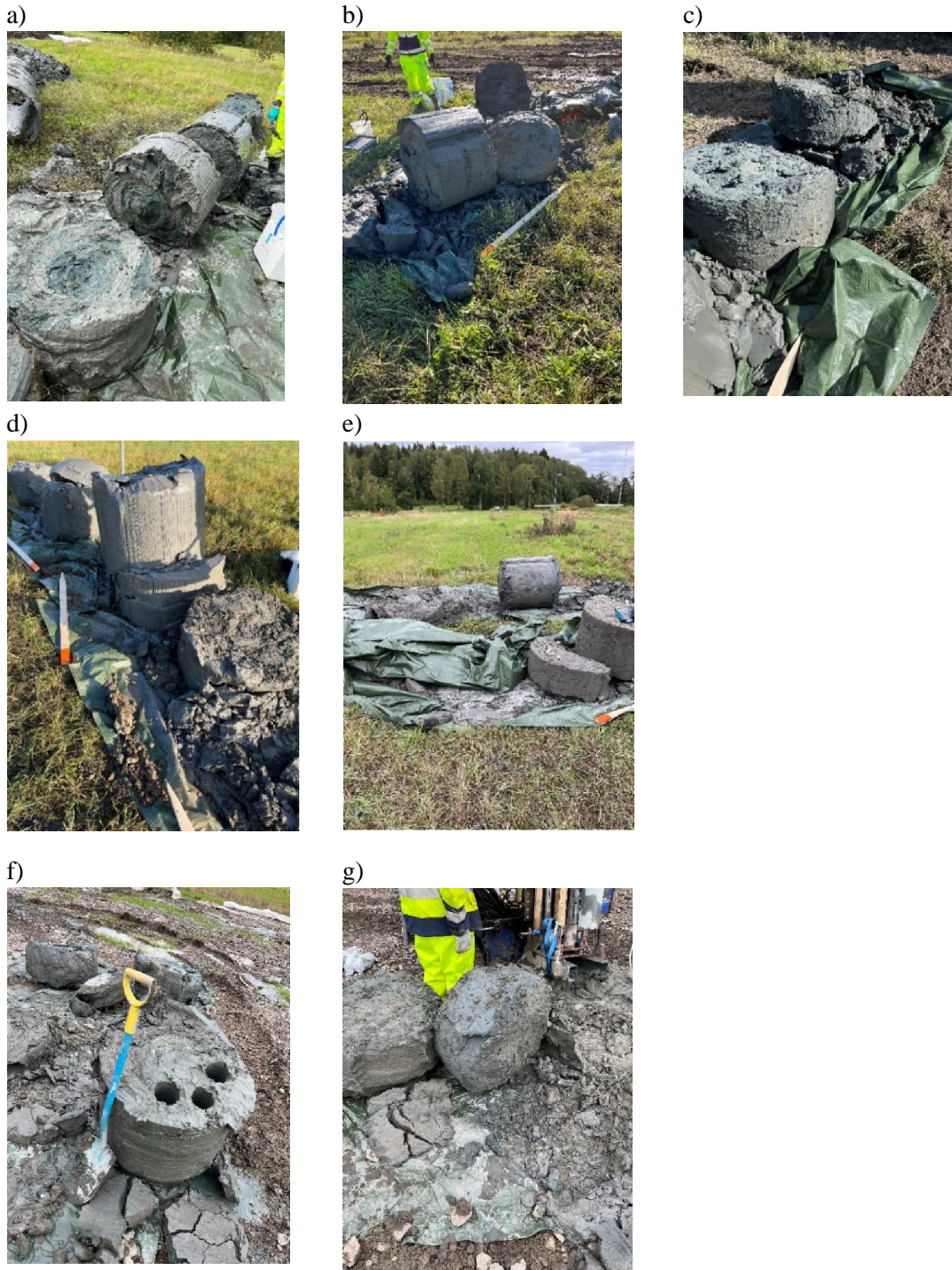
Kuva 20 Nostetut pilarit: a) CEMIII/B, b) Kaukaan voima LT+CEMII, c) Terra GREEN, d) Terra POZ , e) Terra GTC, f) CEMIII/A ja g) UPM LT+CEMII. (valokuvat Otto Kaukoranta 4.9.-12.10.2023).
