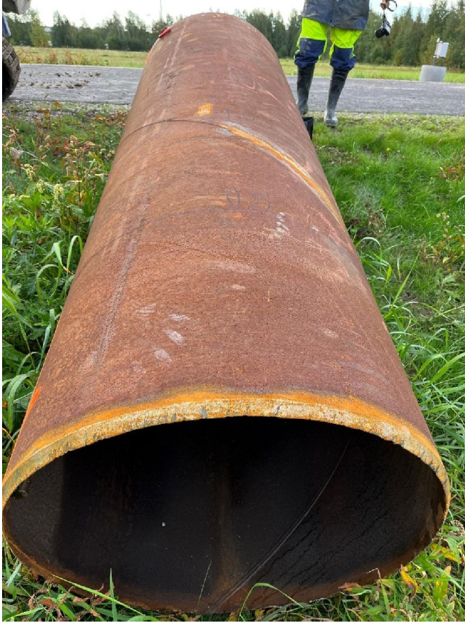
Kuva 18 Nostossa käytetty alapäästään teroitettu teräsputki. (valokuva Otto Kaukoranta 4.9.2023).
