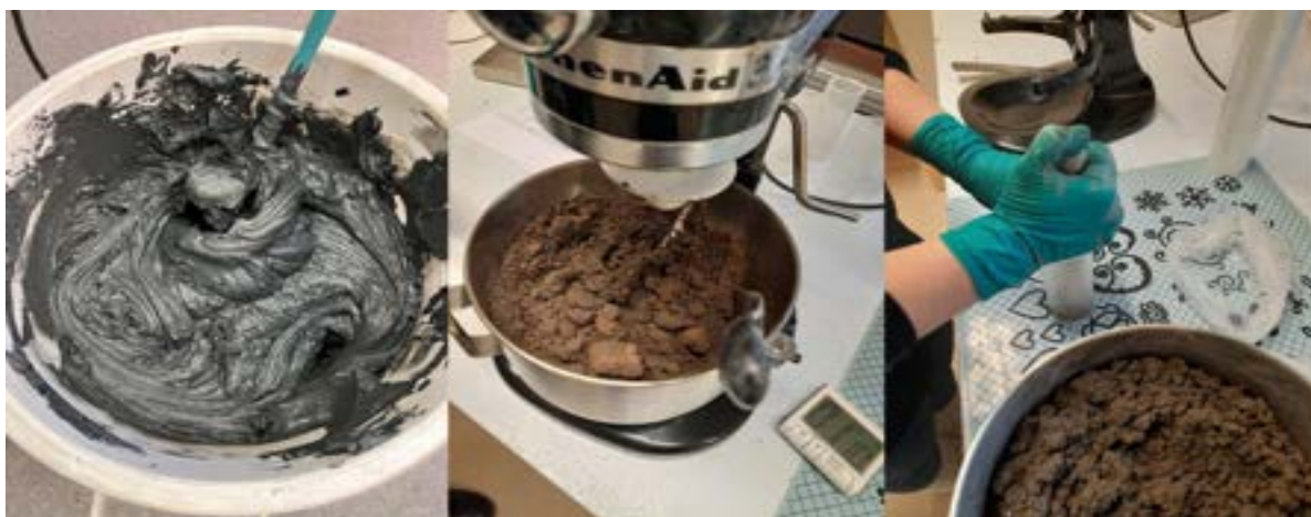
Kuva 28. Savimateriaalin homogenisointia vasemmalla, seoksen valmistus keskellä ja koekappaleen tiivistystä oikealla.
