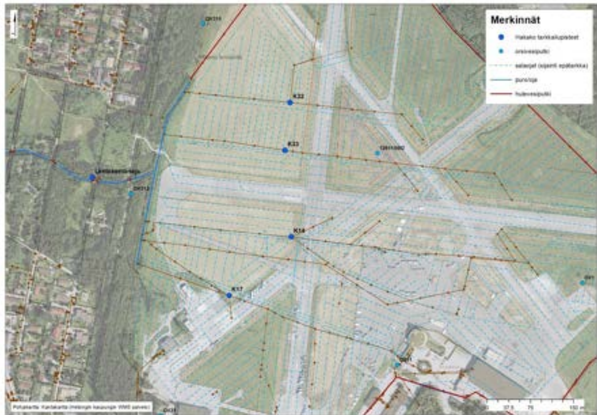
Kuva 1 Malminkentän tarkkailussa seurattiin neljää kaivoa (K17, K14, K33 ja K32), sekä Lentokenttänojaa. Kaivojen vesi muodostuu sekä pintavalunnasta, että salaojien suotovesistä. Lentokenttänojassa sekoittuvat kenttäalueen suotovedet, hulevedet, sekä kentän itäpuolelta tulevat Jarrutienoajan vedet.
