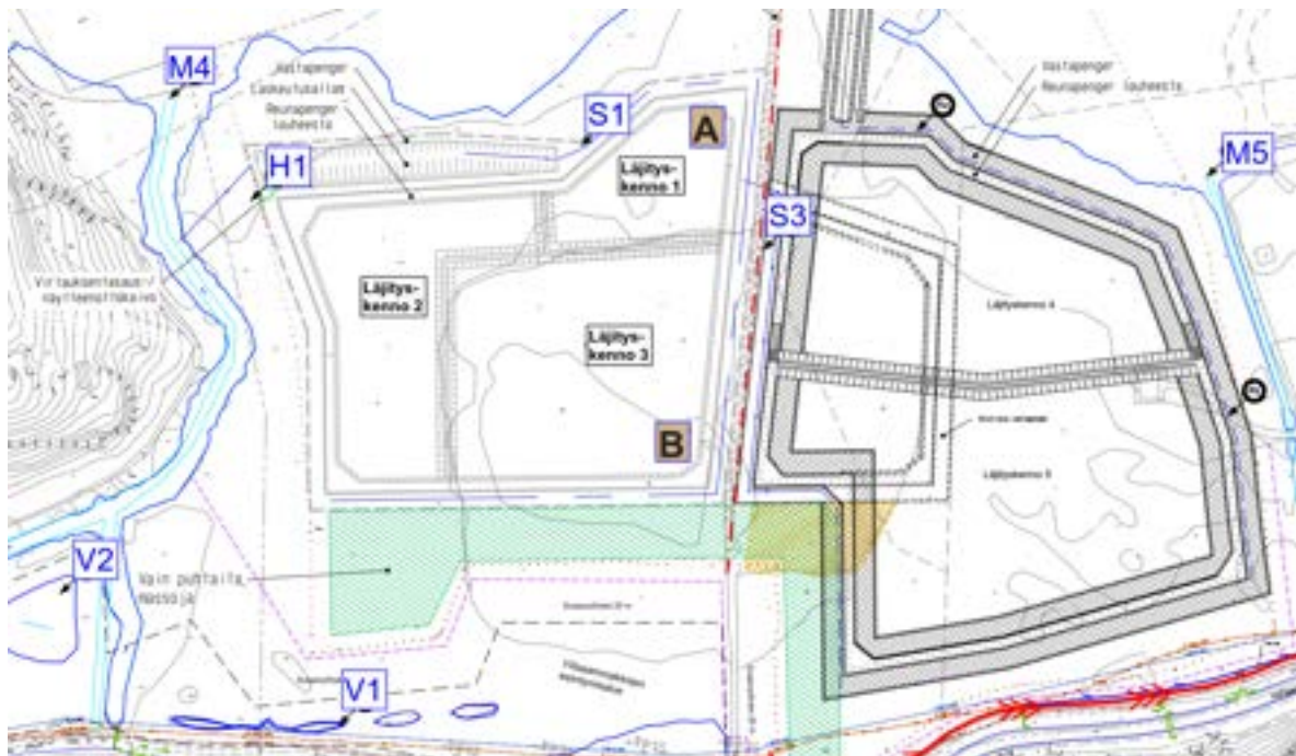
Kuva 8. Näytteenottopisteet ja ruoppausmassa-altaat. M4 ja M5 =Hulevesien laskuojan vedenlaadun tarkkailupisteet rantavedessä. S1 ja S2 =Ruoppausmassojen kuivatukselta muodostuvat suotovedet. H1=Laskeutusaltaan tarkkailukaivo. V1 ja V2 =Viitasammakkoaltaat, jotka eivät kuulu HaKaKo-hankkeen seurantaan. A ja B = Sedimenttinäytepisteet.
