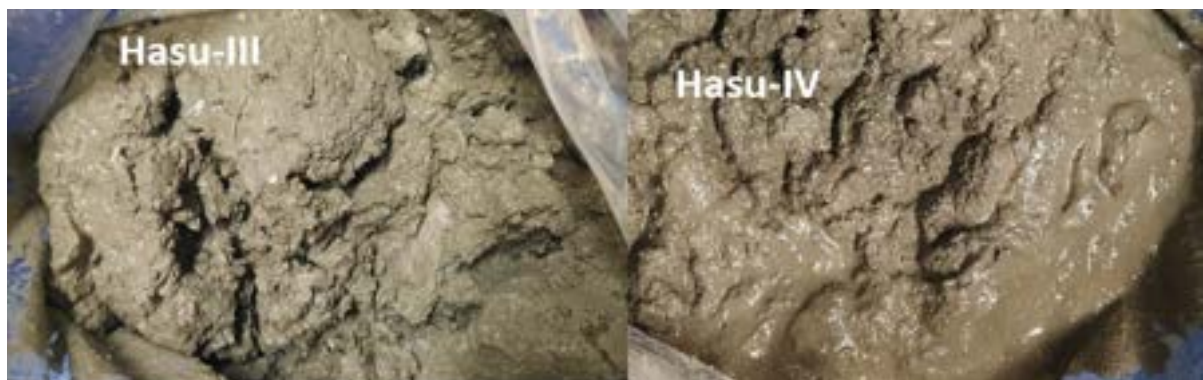
Kuva 18. Jäädytys-sulatuskokeen näytteet 20 viikon inkuboinnin ja neljän sulatuksen jälkeen.
