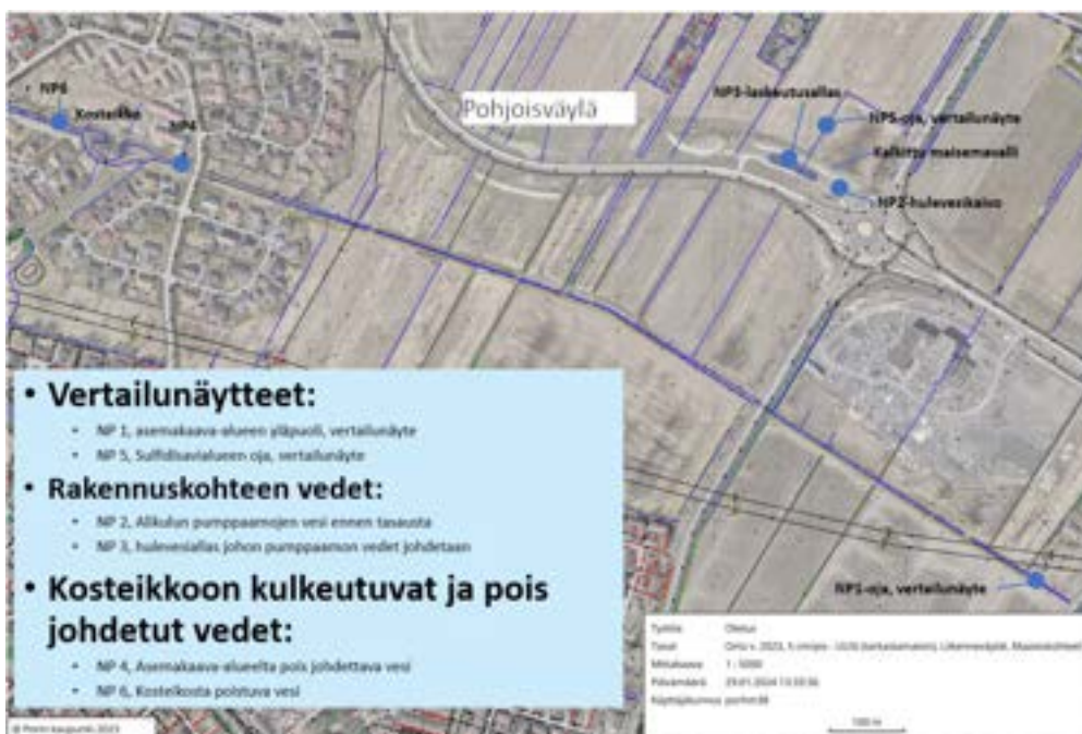
Kuva 5. Porin vesinäytesteiden sijainti, jossa 1=Asemakaava-alueen yläpuolisten vesien laatu kuvaava vertailunäyte. 2= Alikulun rakennusalueelta bentoniittimaton yläpuolelta tuleva vesi ennen vesien tasausta, ylemmän pumppausvesien kuivatusvedet. 3=Hulevesiallas, johon johdetaan bentoniittirakenteen yläpuoliset ja alapuoliset vedet pumpattuna. 4=Asemakaava-alueelta pois johdettava vesi 5=Sulfaattialueella sijaitseva oja, johon ei kohdistu maanmuokkaustoimia, vertailunäyte. 6=Kosteikosta poistuva vesi (esitetty kuvassa 4 NP 6).
