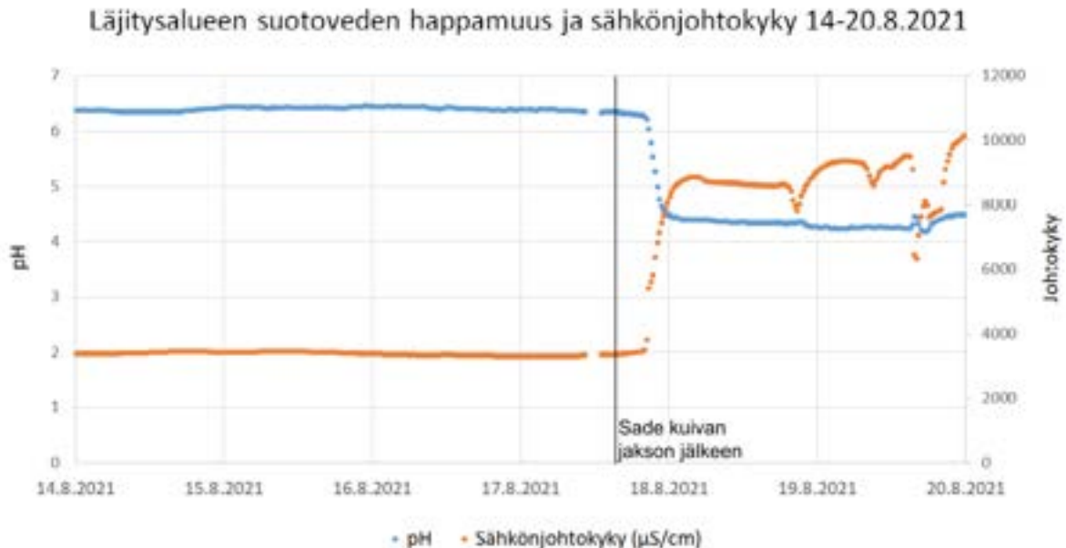
Kuva 10. Vähäsateisen jakson jälkeen ajoittuneet sateet aiheuttivat selkeän muutoksen läjitäalueelta tulevan salaojaveden laadussa. 17.8 iltaan ajoittuneen sateen seurauksena veden pH arvo laski arvosta 6,3 → <4,5 noin neljän tunnin aikana. Samanaikaisesti veden sähkönjohtokyky kasvoi noin 3 500 µS/cm → >8000 µS/cm. (Auri ym. 2022)
