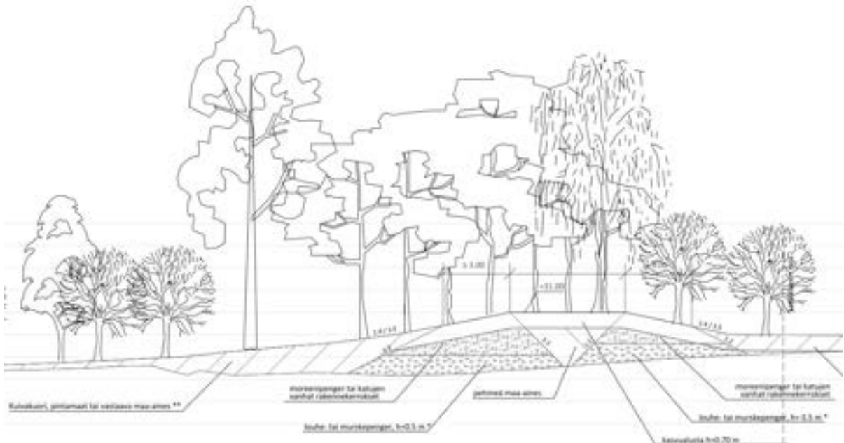
Kuva 15. Ote happamien sulfaattimaiden läjitysalueen rakennussuunnitelmasta.
