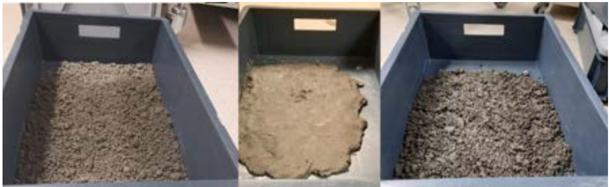
Kuva 23. Inkubointi-koejärjestely, keskellä kalkittu näyte ja sivuilla tuhalla neutraloidut näytteet. Näytteiden seossuhde on laskettu varmuuskertoimella 2.
