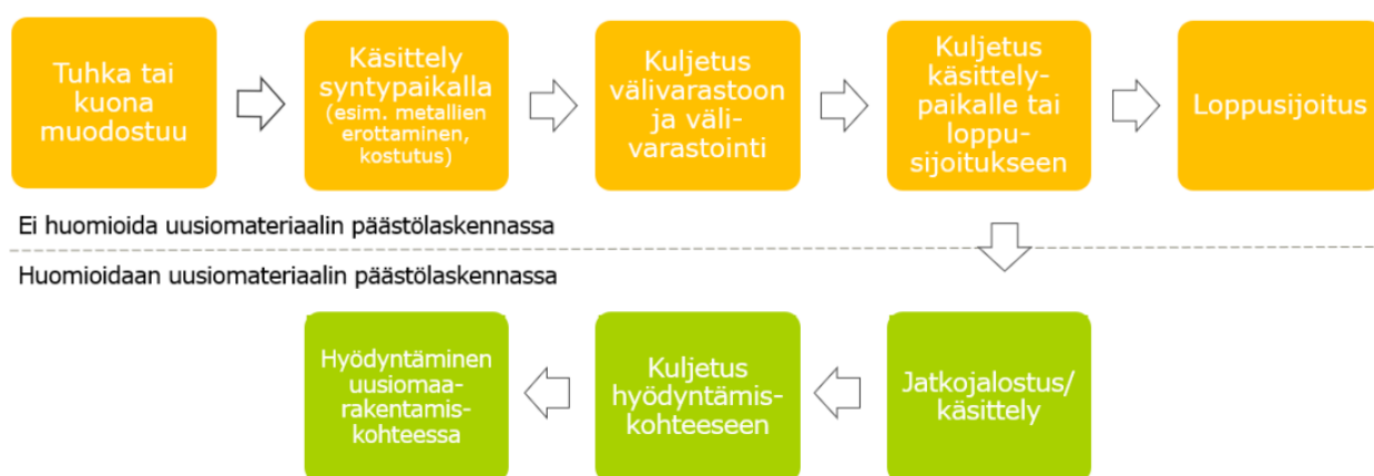
Kuva 26. Esimerkki uusiomateriaalin elinkaaren vaiheiden huomioimisesta päästölaskennassa. Oranssien laatikoiden vaiheita ei oteta huomioon uusiomateriaalin päästöjen laskennassa, sillä ne kuuluvat pääprosessin (esim. energiantuotanto) elinkaareen. (Teittinen et al. 2020)
