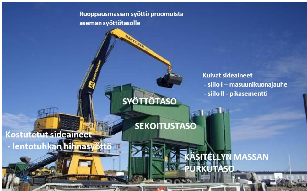
Kuva 2.7 Prosessistabilointilaitteisto. Toimintaperiaate Pansion kohteessa. (Autiola et al. 2009)
