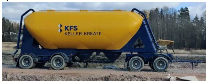
Kuva 2.8. Sideaineen varastosäiliö (a) ja stabilointikoneeseen liitetty säiliö (b) (Ketonen 2020).
