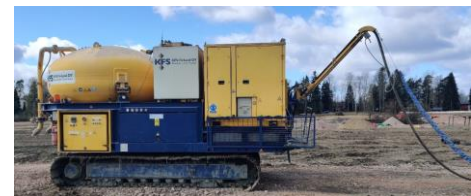
Kuva 2.8. Sideaineen varastosäiliö (a) ja stabilointikoneeseen liitetty säiliö (b) (Ketonen 2020).
