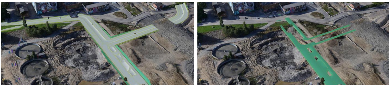
Kuva 8.2 Kadunrakennussuunnitelman koneohjausmallissa betonimurskeesta tehtävä jakava kerros näkyy oikeanpuoleisessa kuvassa (Tampereen Hiedanranta, Hiedanrannan Kehitys Oy).
