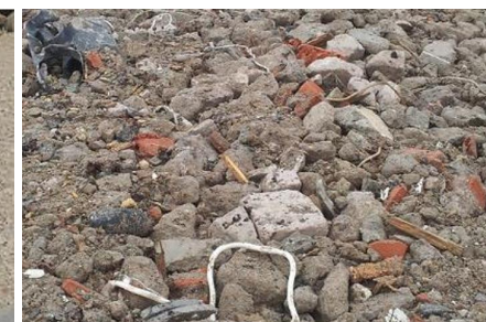
Betonimurske, ei vaatimukset täyttävä
