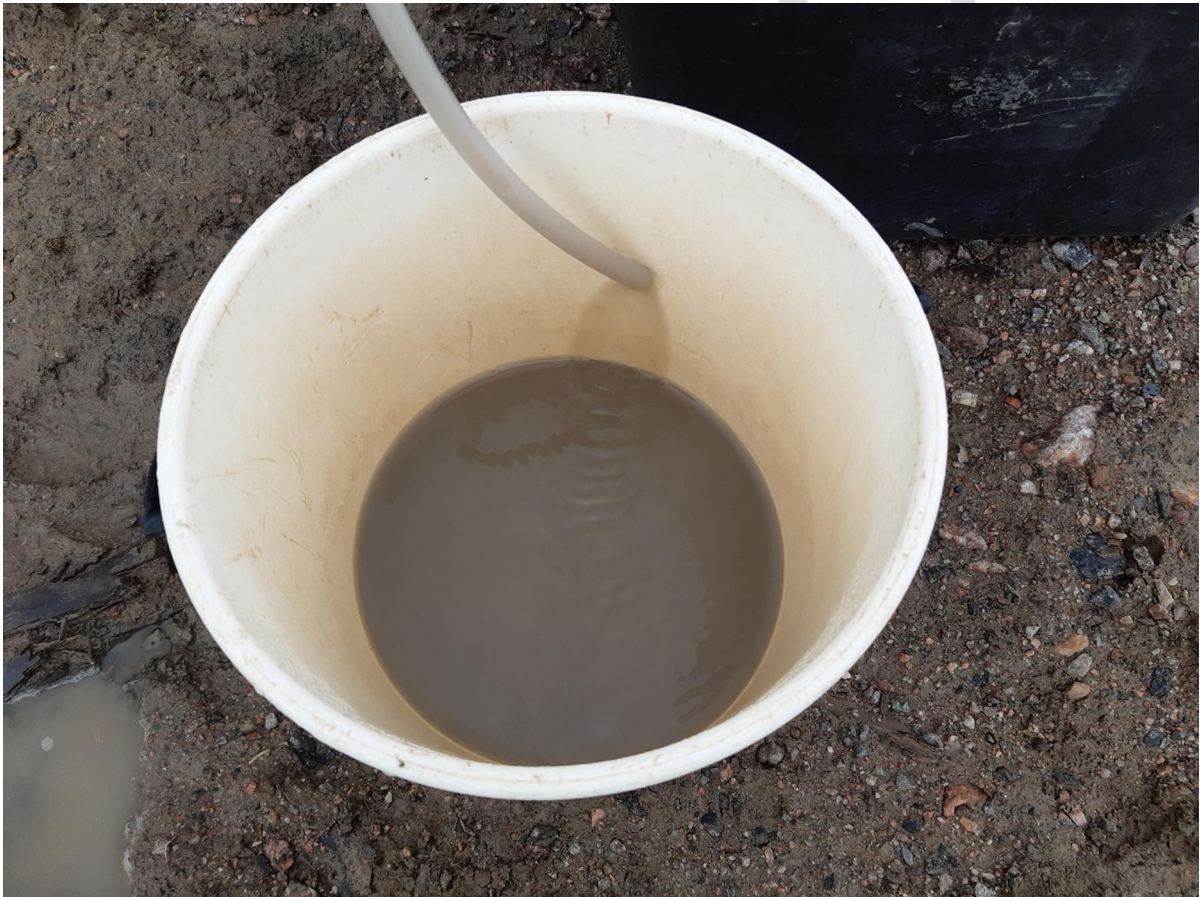
Kuva 3. Pohjavesiputkien PVP1 ja PVP3 vesi ei kirkastunut huhtikuun näytteenoton aikana eikä YSI-kenttämittauksia pystytty tekemään.
