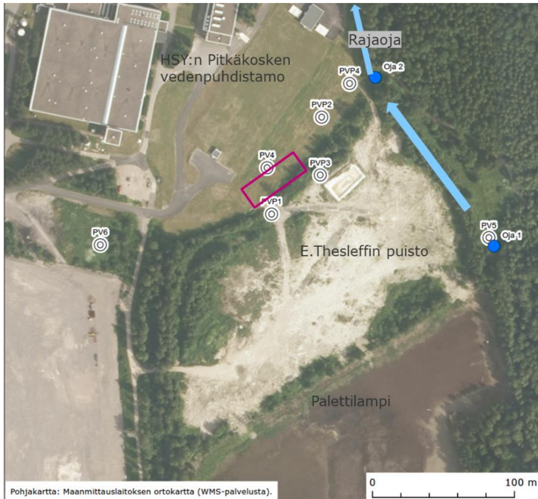
Kuva 6. Ympäristöntarkkailun tutkimuspisteet Kuninkaantammessa. Sininen ympyrä=pintavesi (oja 1 ja oja 2), valkoinen ympyrä=pohjavesi. Lilalla rajattu alue kuvaa koestabilointialuetta (liikemääräinen).
