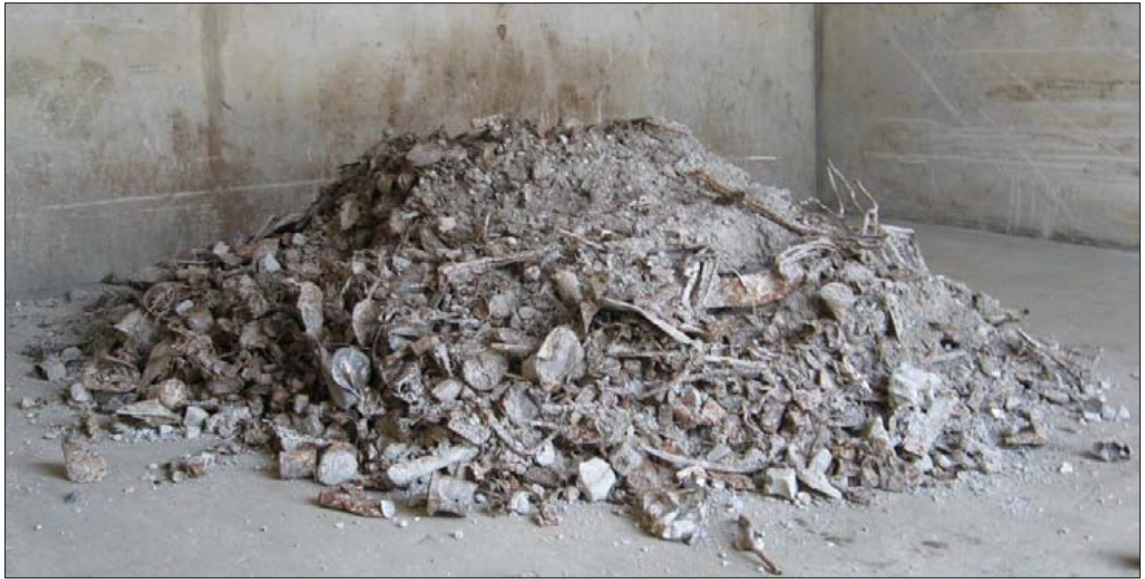
Kuva 3.3. Esimerkkikuva jätteenpolttolaitoksen pohjakuonanäytteestä (VTT 2010).
