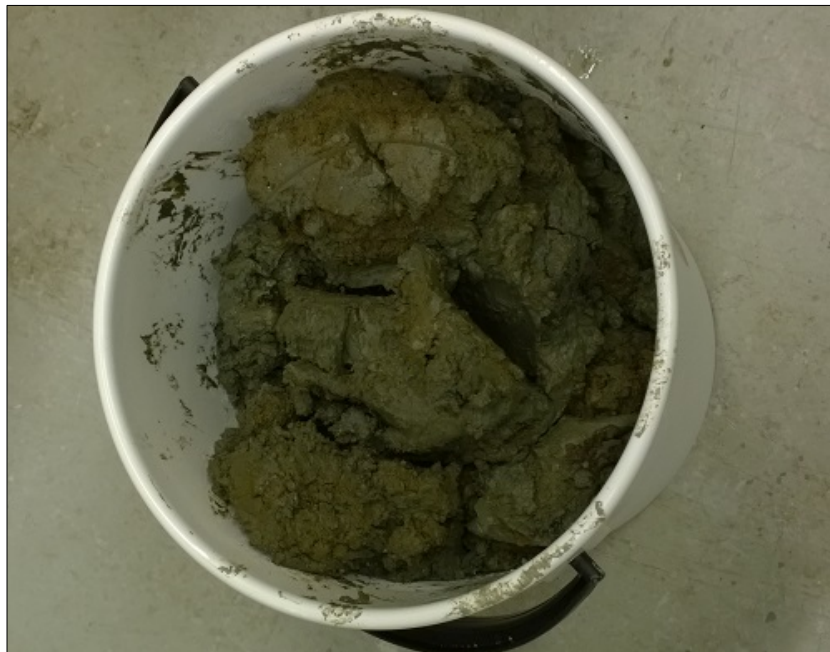
Kuva 4.5. Stabiloitavuuskoetta varten kerätty savinäyte Leppäkorvesta (Wigren & Gunnelius 2015).
