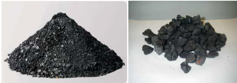
Kuva L2-7. OKTO-murske, jota valmistetaan eri fraktioihin, esimerkkinä vasemmalla 0/5 mm ja oikealla 16/22 mm raekoot.
