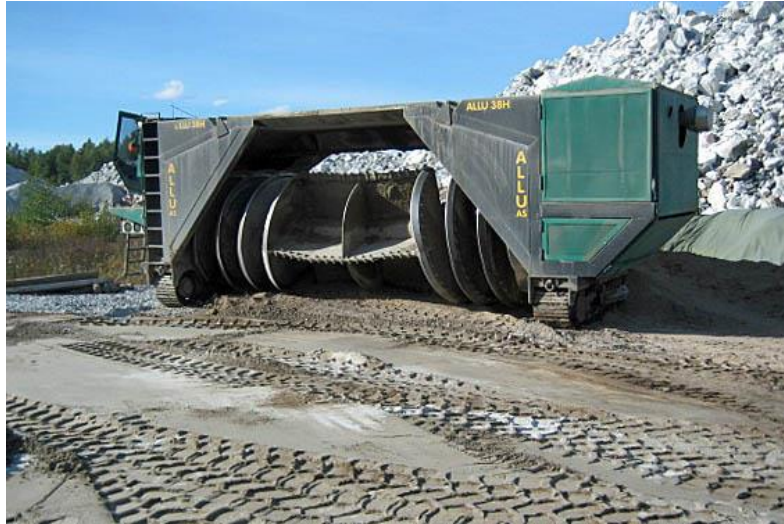
Kuva 3.2. Aumasekoitin, jolla voidaan suorittaa mm. materiaalien sekoitustyötä. Erilaisia materiaalien sekoitus-/työmenetelmiä on esitetty liitteessä 4.
