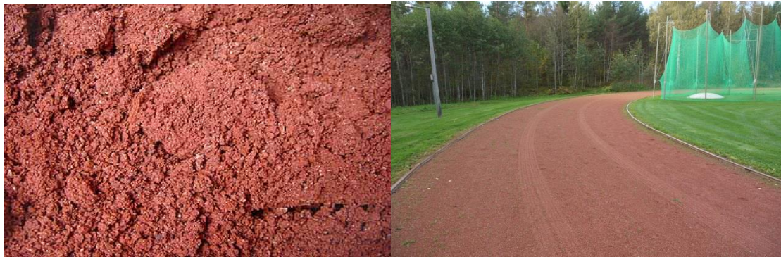
Kuva L2-2. Tiilimurskaa voidaan käyttää esimerkiksi tenniskentän tai juoksuradan pintamateriaalina.
