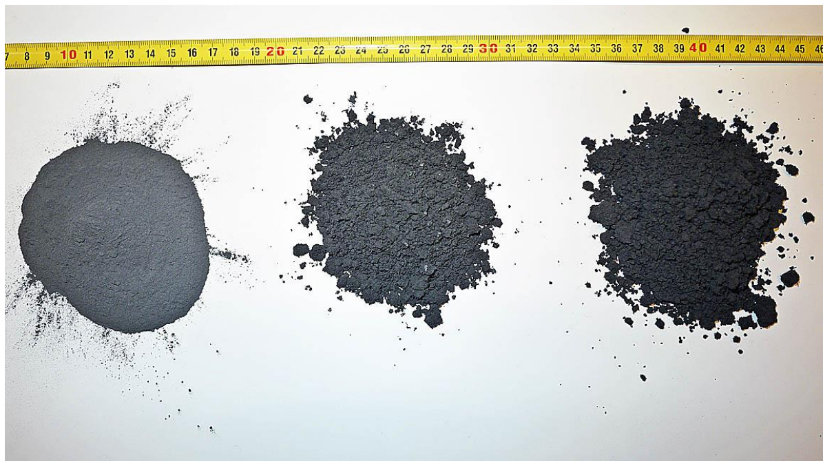
Kuva L2-3. Esimerkinomainen suuntaa antava kuva lentotuhkan olemuodosta eri vesipitoisuuksissa: vasemmanpuoleinen w < 1\% , keskellä w = 26\% (tässä tapauksessa optimi), oikealla w = 41\% . (Ramboll 2013)
