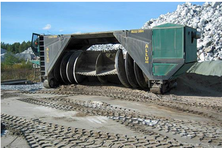
Kuva L4-4. Yksi vaihtoehto materiaalien sekoitus- ja homogenisointityötavaksi on myös aumasekoitin.
