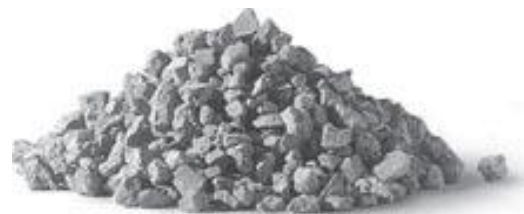
Kuva L2-6. Masuunikuonamurske, jota valmistetaan eri fraktioihin.
