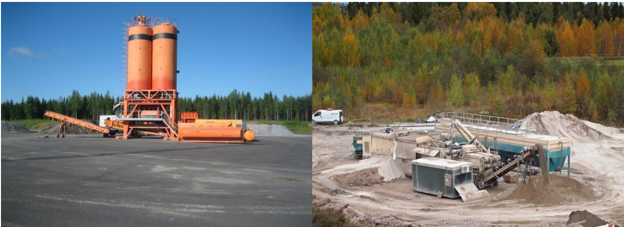
Kuvat L4-1 ja L4-2. Erityyppisiä asemasekoittimia, joilla sekoitustyön lopputulos on homogeeninen ja määräsuhteet erittäin tarkat.
