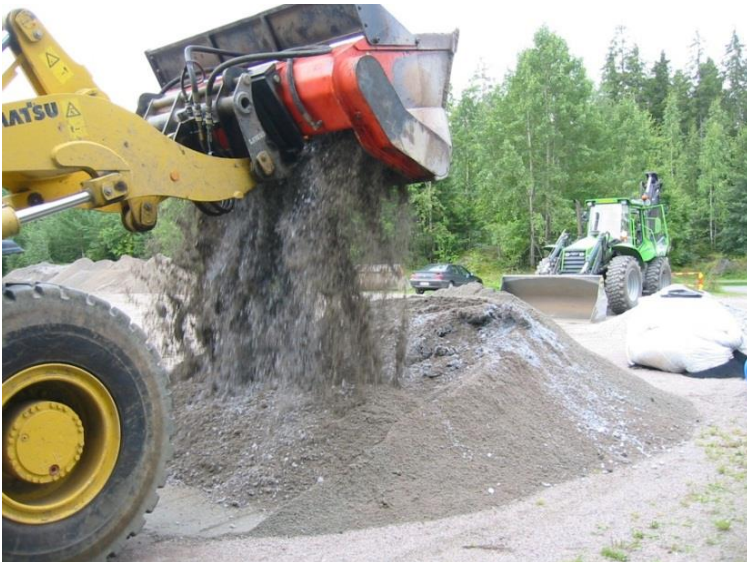
Kuva L4-3. Yksi vaihtoehto materiaalien sekoitus- ja homogenisointityötavaksi on seulamurskainkauha.
