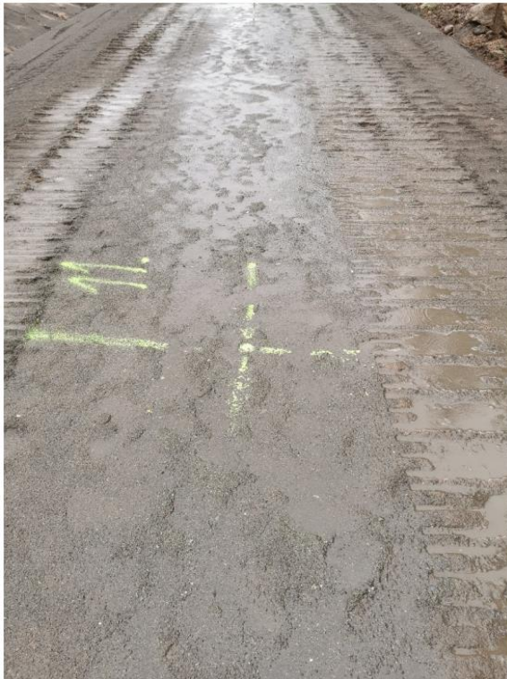
Kuva 6. Koemateriaalin liettynyt pinta (Matikka 2021).
