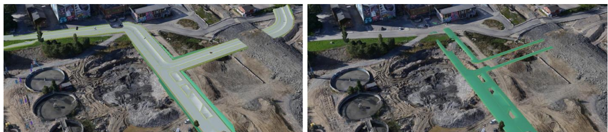
Kuva 8.2 Kadunrakennussuunnitelman koneohjausmallissa betonimurskeesta tehtävä jakava kerros näkyy oikeanpuoleisessa kuvassa (Tampereen Hiedanranta, Hiedanrannan Kehitys Oy).
