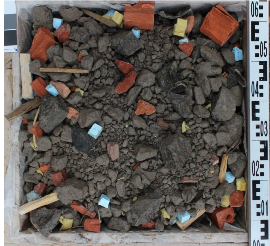
MÄRKÄ BETONIMURSKE (BeM II tai III)
