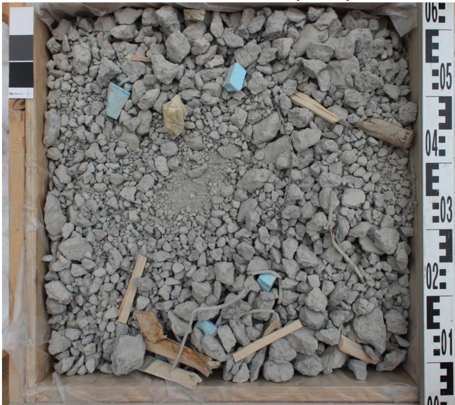
KUIVA BETONIMURSKKE (BeM I)
