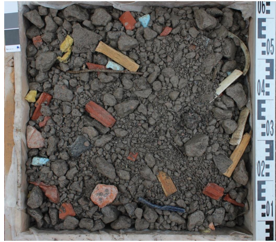
MÄRKÄ BETONIMURSKE (BeM II tai III)
