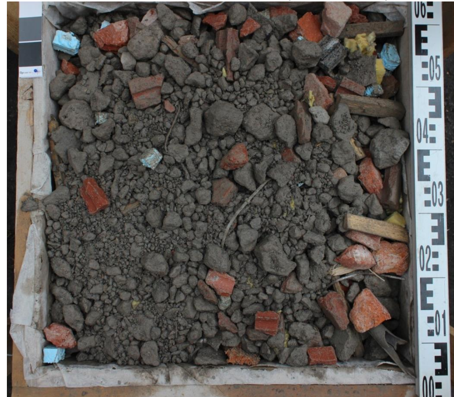
MÄRKÄ BETONIMURSKE (BeM II tai III)
