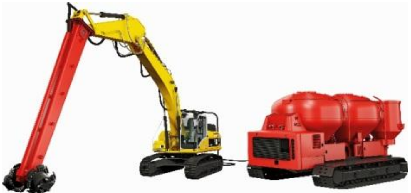
Kuva 2.2. Massastabiloinnin perusyksikkö, jossa on stabilointiyksikkö kiinnitettynä kaivinkoneeseen ja liitettynä painesyöttimeen.
