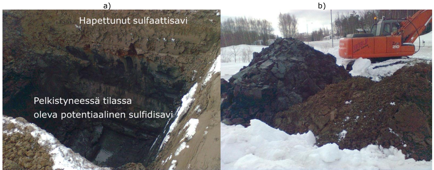
Kuva 4.16. a) Musta sulfidisavi syvämmällä koekuopassa sekä b) musta sulfidisavi vasemmalla ja hapettunut, ruskeaksi muuttunut savi oikealla (valokuva: Jonas Aspholm 2011).
