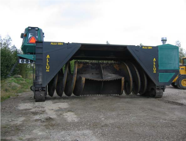
Kuva 7: Aumasekoitinta on mahdollista käyttää materiaalien sekoittamiseen vain erillisellä sekoitusalueella.
