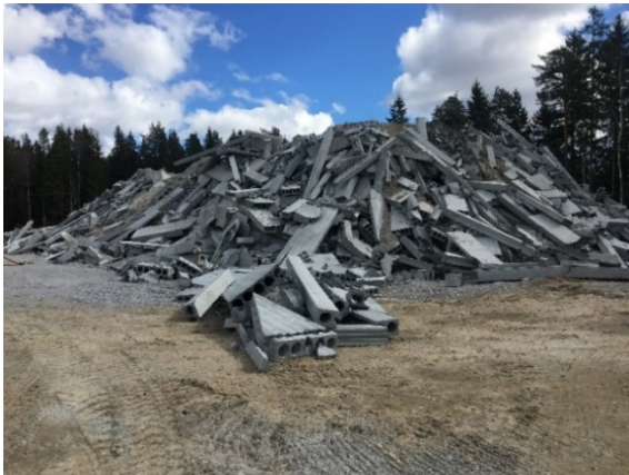
Kuva 1. a) Murskattavia betonielementtejä ja b) murskattua puhdasta BeM I-luokan 0/45 mm raekokoista betonimursketta murskausasemalla.
