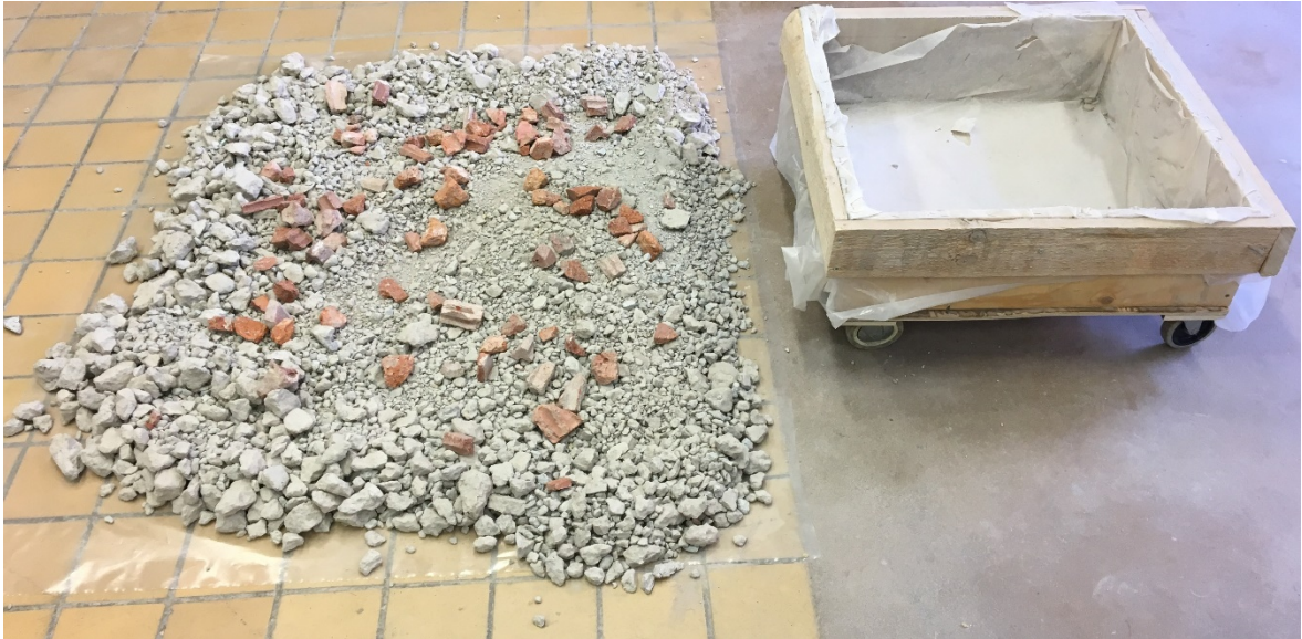
Kuva 12. Näytelaatikko ja materiaalin sekoitus muovin päällä. Kuvassa näkyy hienomman ja rakeisemman betonimurskeen lajittumista ja punatiiltä.
