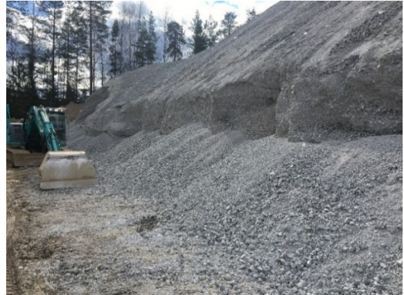
Kuva 1. a) Murskattavia betonielementtejä ja b) murskattua puhdasta BeM I-luokan 0/45 mm raekokoista betonimursketta murskausasemalla.
