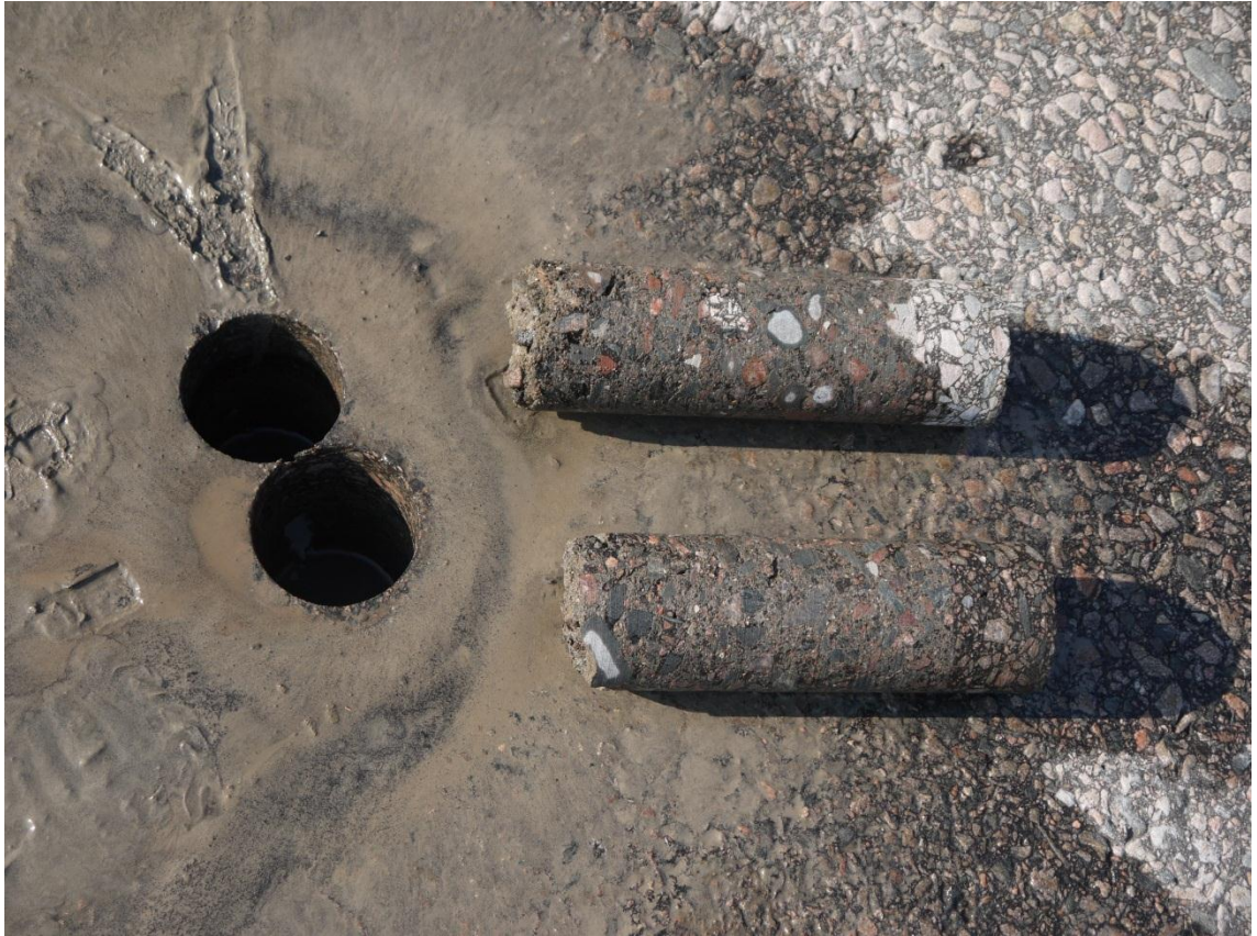
Kuva 6.18. Tieltä 16563 paalulta 3325 vuonna 2013 poratut näytekappaleet, joissa päällyste pysyi kiinni stabiloinnissa porauksen ajan. (Kuva: Mäkinen, 2013)
