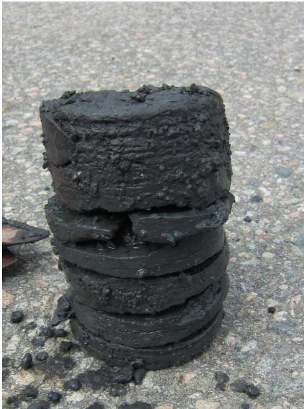
Kuva 6.11. Inkoon koekohteen massiivituuhkarakenteesta vuonna 2013 paalulta 3820 porattu näyte
