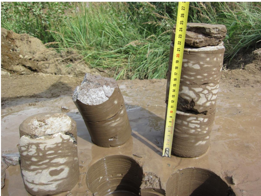
Kuva 6.47. Leppävirran koekohteen massiivituhkarakenteesta porattuja näyttekappaleita
