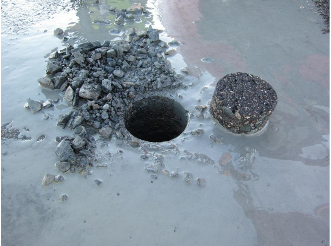
Kuva 6.56. Vuosaaren satamakentän tuhkarakenteesta pisteestä 11 vuonna 2013 porattu näyte
