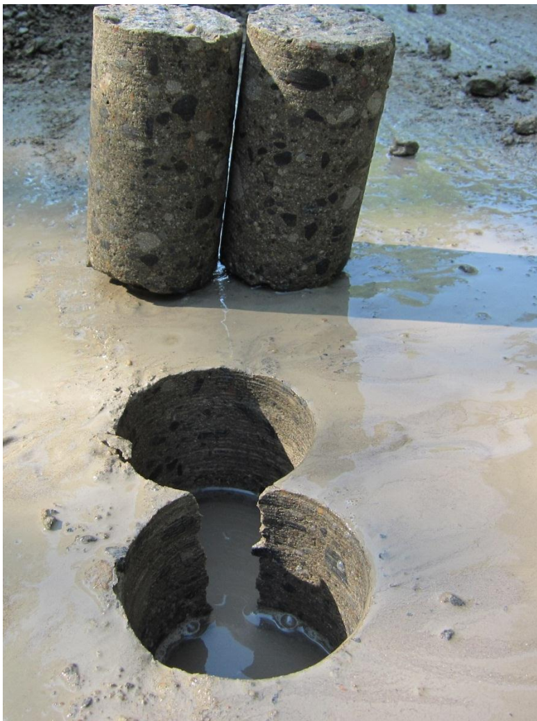
Kuva 3.5. Kerrosstabiloidusta kantavasta kerroksesta porattuja näytekappaleita.
