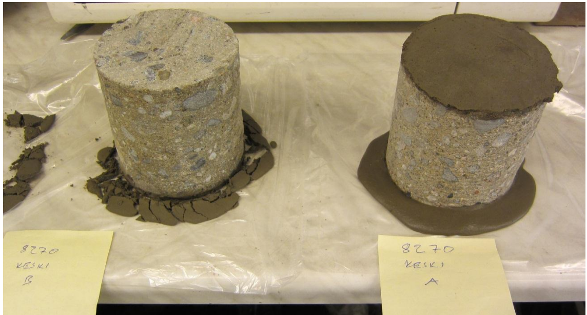
Kuva 5.3. Koekappaleiden valmistelua puristuslujuuden määrittämiseen.
