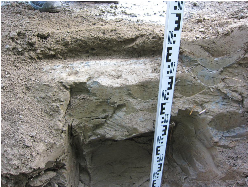
Kuva 6.48. Leppävirran koekohteessa paalulla 1960 havainnoitu tuhkarakenteen alusrakenne
