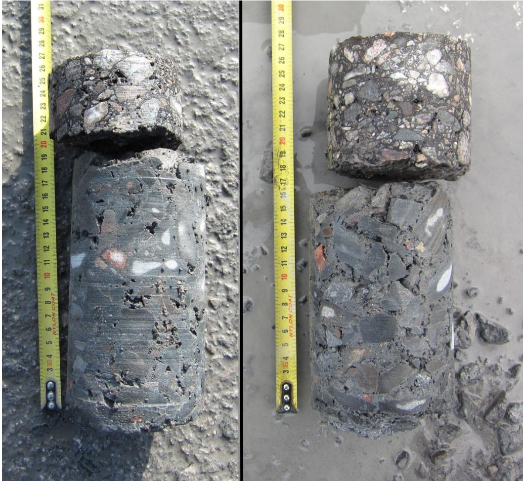
Kuva 6.58. Vuosaaren satamakentältä vuonna 2013 porattuja näyttekappaleita, vasemalla pisteestä 24/30 ja oikealla pisteestä 13
