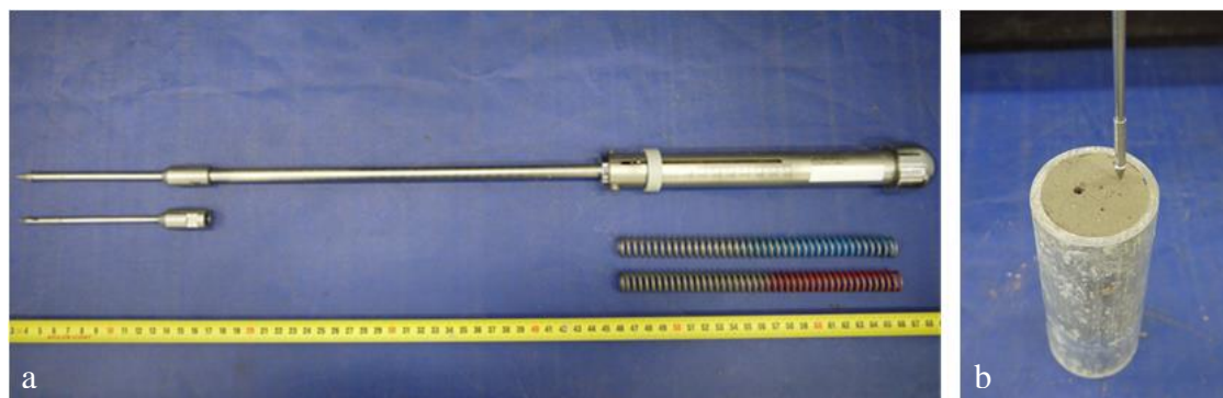
Kuva 39: Saven ja liejun penetrimääritys: a) penetrometrilaitteisto, b) stabiloidun savikoekappaleen penetrimääritys.
