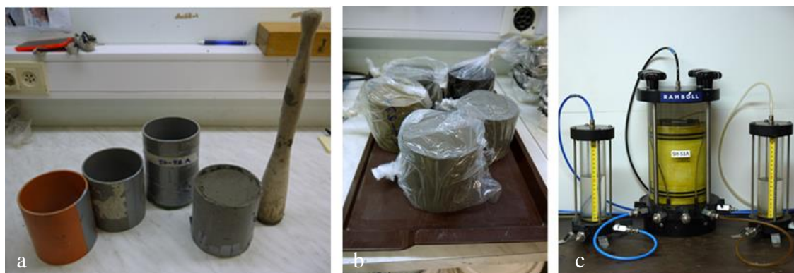
Kuva 42: Vedenläpäisevyyden määrittäminen: a) vedenläpäisevyysmuotteja ja sullontanuija, b) valmiita vedenläpäisevyyskoekappaleita, c) vedenläpäisevyyskoelaitteisto.
