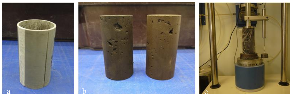
Kuva 45: Turpeiden puristuslujuuden määrittäminen: a) puristuskoekappaleiden tasaamisessa käytetty 136 mm korkuinen muotti, b) valmiita puristuskoekappaleita, c) koekappale yksiaksiaalisessa puristuskokeessa.
