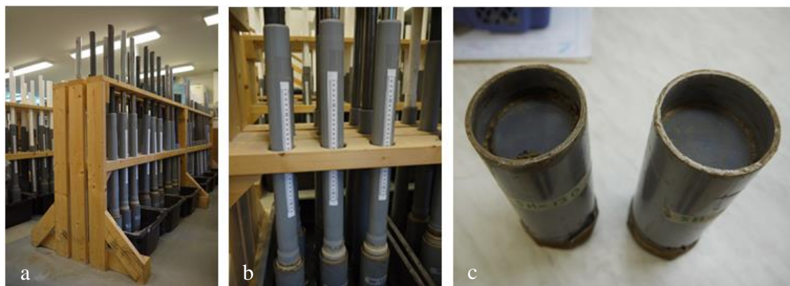
Kuva 44: Turpeen esikuormitus: a) esikuormituspenkki, b) painuman mitta-asteikko, c) esikuormitettuja turvekoekappaleita.
