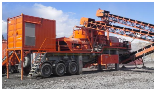
Kuva 2 a) Kiviaineksen syöttö esimurskaimelle, b) Välikartiomurskaimet (kuva: Riina Rasimus 2013)
