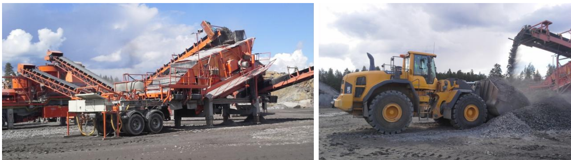
Kuva 3 a) Prosessiseula, b) Valmiin lopputuotteen siirto pyöräkuormaajalla varastokasalle (kuvat: Riina Rasimus 2013)
