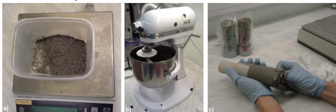
Kuva 17 Savikoekappaleiden valmistus: a) Sideaineen ja kivituhkan punnitus, b) laboratoriosekoitin massan sekoittamiseen, c) sekoitetun massan sullonta muottiputken sisään (kuvat: Riina Rasimus 2013)
