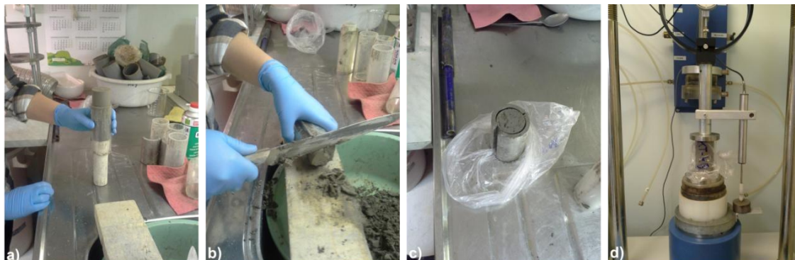
Kuva 18 Savikoekappaleiden valmistelu puristuslujuuskokeeseen: a) Koekappaleen tunkkaus ulos muottiputkesta, b) Koekappaleen lyhennys oikeaan mittaan, c) Lyhennetty koekappale leikkausmuotissa, d) Savikoekappaleen puristus (kuvat: Riina Rasimus 2013)
