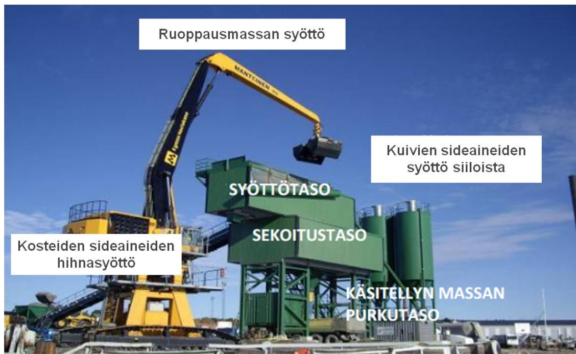
Kuva 14 Prosessistabilointikalusto (muokattu Autiola 2009)
