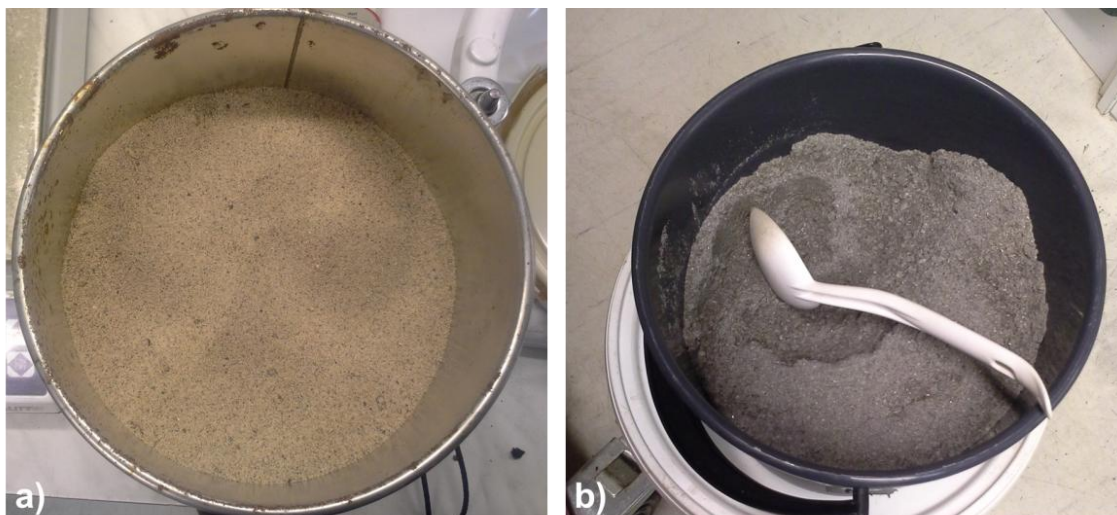
Kuva 16 Käytetyt täyteaineet: a) Hiekka 0/2 mm; b) Kivituhka 0/6 mm. (kuvat: Riina Rasimus 2013)
