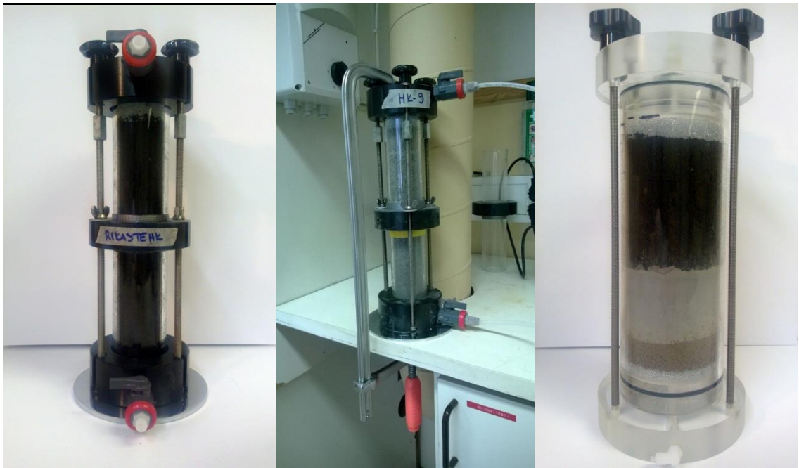
Kuva 26. Materiaalien haitta-aineliukoisuuksien määrittäminen läpivirtaustestillä (Ramboll 2014).
