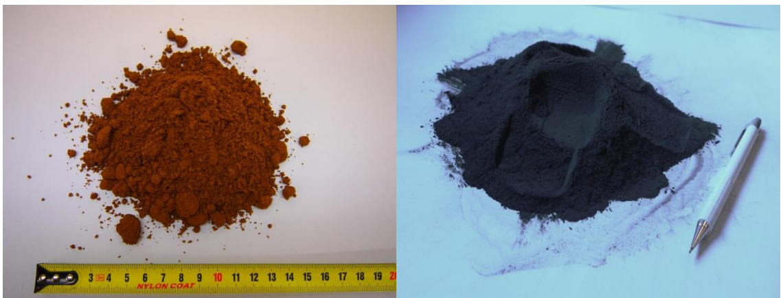
Kuva 7. Puun ja turpeen poltossa muodostunutta kostutettua siilotuhkaa (vasen) ja kuivaa tuhkaa (Ramboll 2014).
