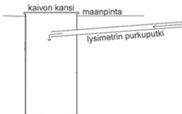
Kuva 4. Lysimetrikaivo, ei mittakaavassa
