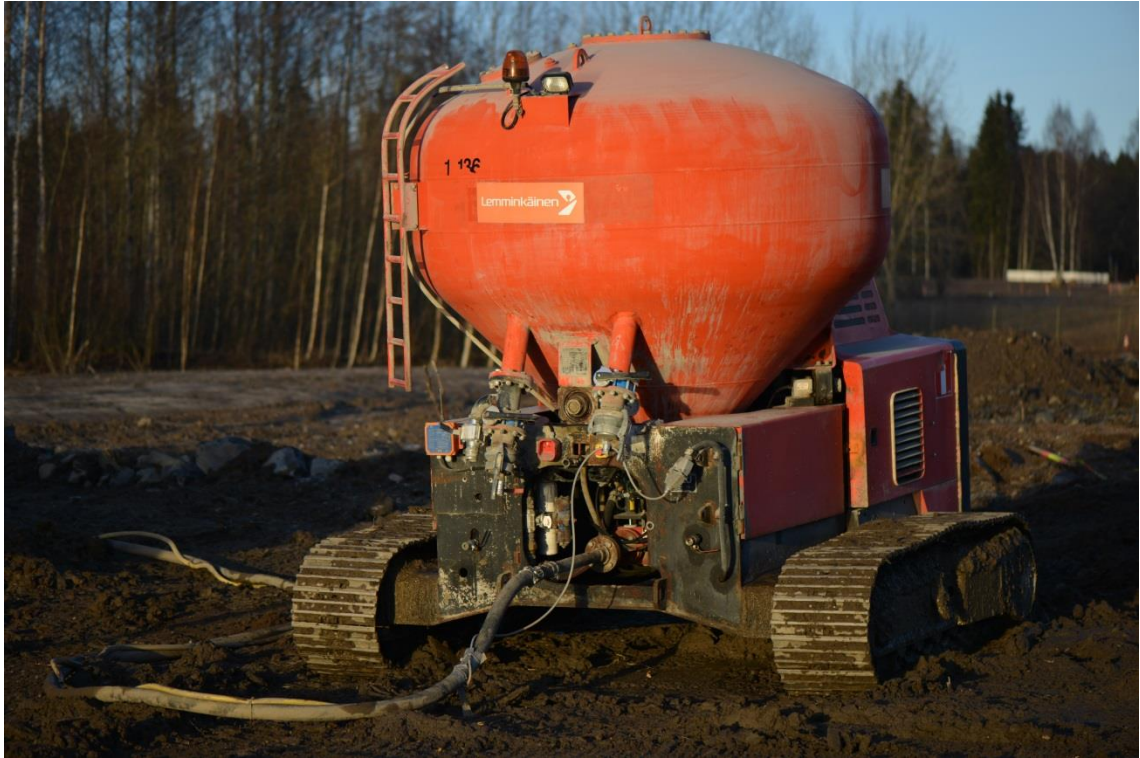
Kuva 8.8. Sideaineen syöttämiseen käytetty painesyötin. (Kuva: Juha Nikkilä, 8.12.2015)
