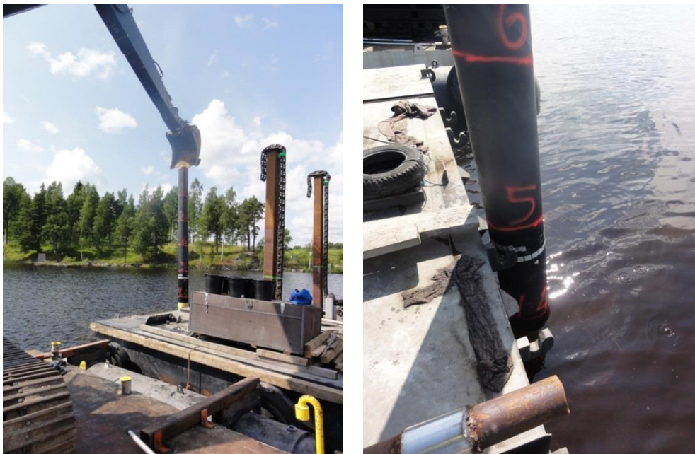
Kuva 7.2. Näytteenotto kaivinkoneen kauhalla painettavalla putkella, jonka halkaisija on 400 mm.
