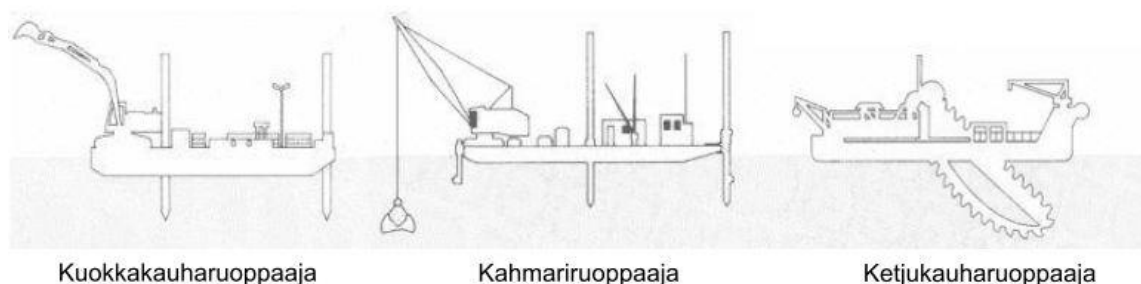
Kuva 4.1. Kauharuoppauskalustoa (Vlasblom 2003, muokattu).
