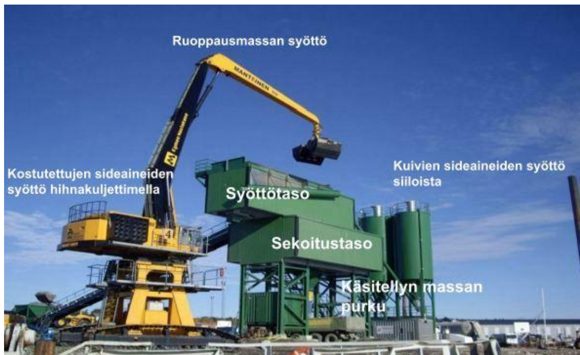
Kuva 5.5. Prosessistabilointia sekoitusasemassa Pansion satamassa Turussa. (Autiola 2009, muokattu)
