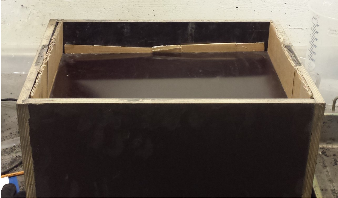
Kuva 7. 11 Resistanssin mittauksessa käytetty pienempi näytetilavuus.
