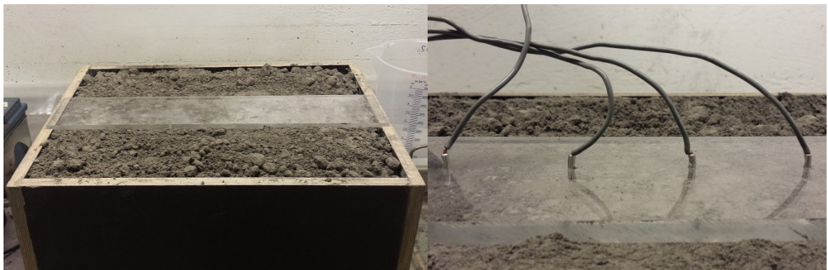
Kuva 7. 10 Koelaatikko täytettynä LTI-näytteen ja veden seoksella valmiina ominaisvastuksen mittausta varten (vas.) sekä lähikuva elektrodeista mittauksen aikana (oik.).
