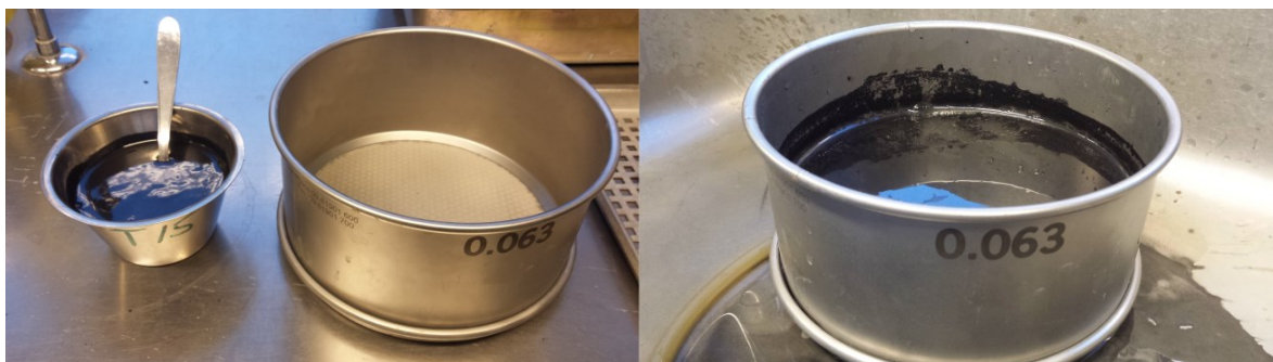
Kuva 7. 5 Tutkimuksessa käytetyn lentotuhkanäytteen pesuseulonta.
