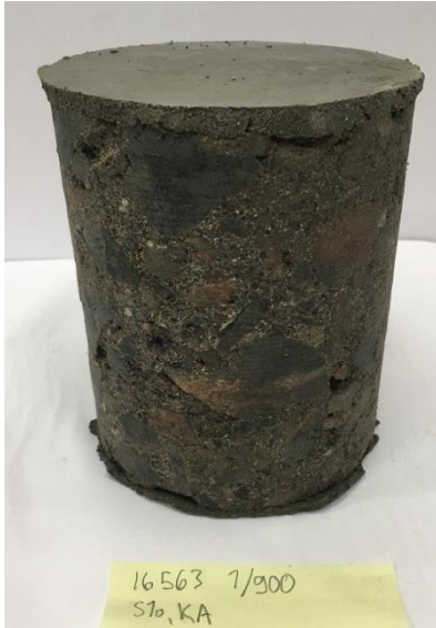
Kuva 11. Yksiakiaalista puristuskoetta varten valmisteltu näyttekappale, jonka päät on tasattu sementtilaastilla (26.5.2017, Ilari Harju).
