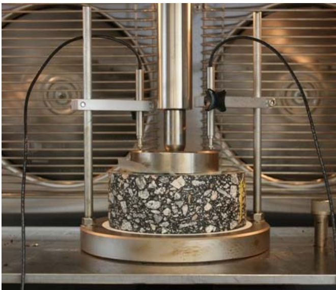
Kuva 11. Tiivistetyn asfalttimassan pysyvän muodonmuutoksen määrittäminen jaksollisella virumiskokeella.
