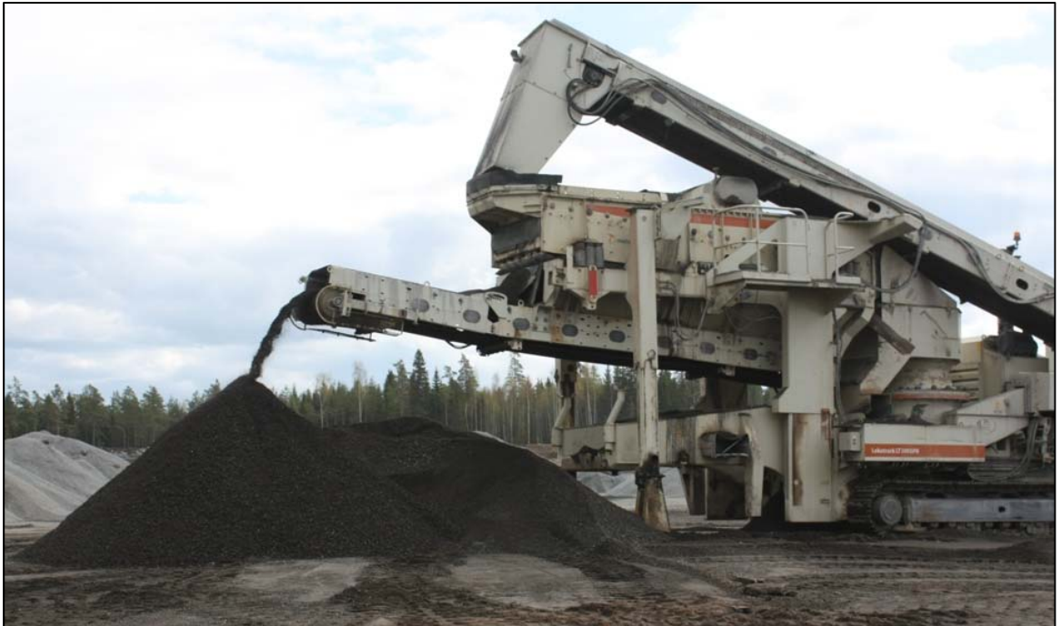
Kuva 7. Asfalttirouheen murskausta asfalttiasemalla.
