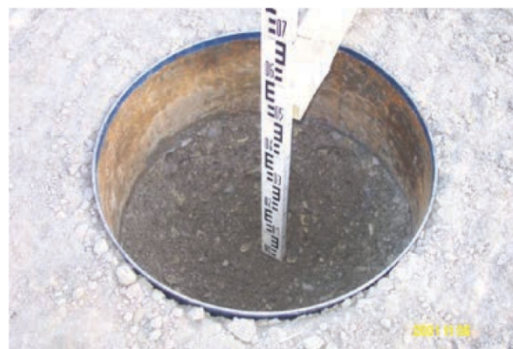
Kuva 13. Tiheyden määrittäminen teräsputken avulla (Kjell Eriksen, Statens vegvesen 2012)
