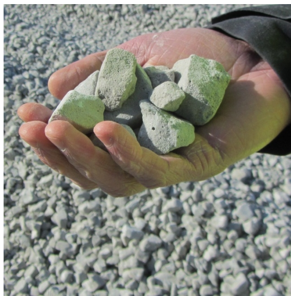
Kuva 16. Käsittelyn aikana kulmistaan pyöristynyttä vaahtolasimursketta (Emilia Köyljärvi 2013)
