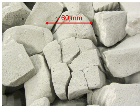
Kuva 36. Halkeillut yksittäinen vaahtolasimurskerake tiivistyksen jälkeen näytteen yläpinnassa. (Emilia Köyljärvi 2013)
