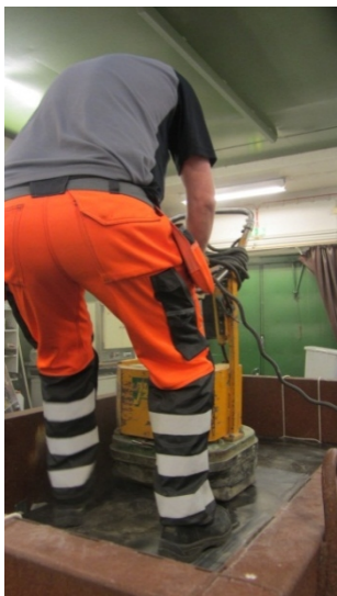
Kuva 28. Tiivistyskoenäytteen tiivistys täräjäjyrällä vanerilevyn päältä (Emilia Köylijärvi 2013)
