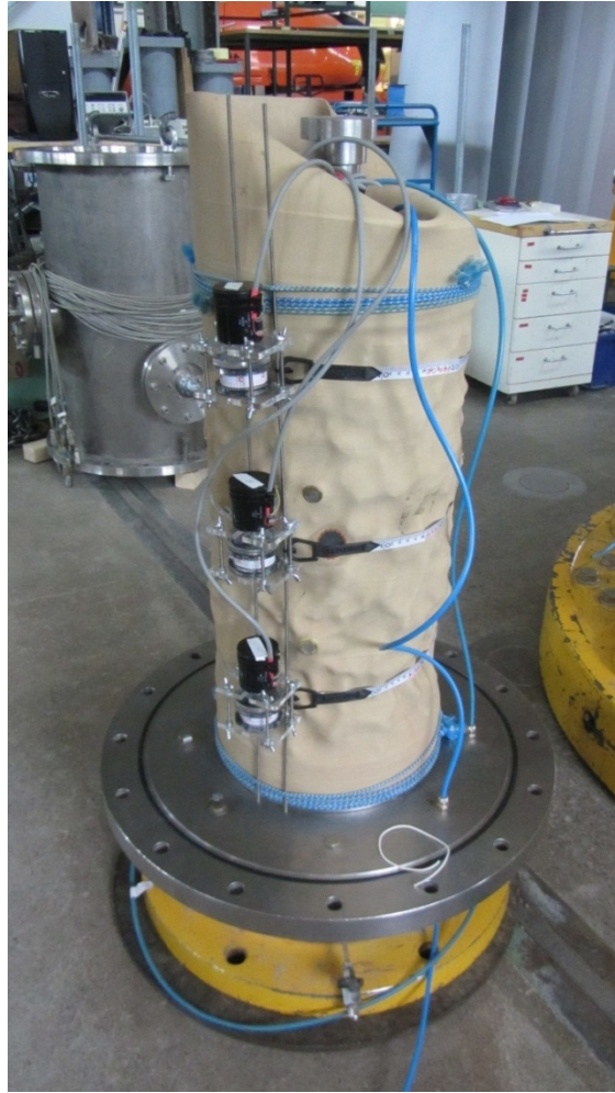
Kuva 31. Kolmiakksiaalikoenäytteen ympärysmitan muodonmuutoksen mittalaitteisto. 20 kPa sellipaineessa kuormitettava vaahtolasimurskenäyte ennen terässällin paikalleen asentamista. (Emilia Köylijärvi 2013)
