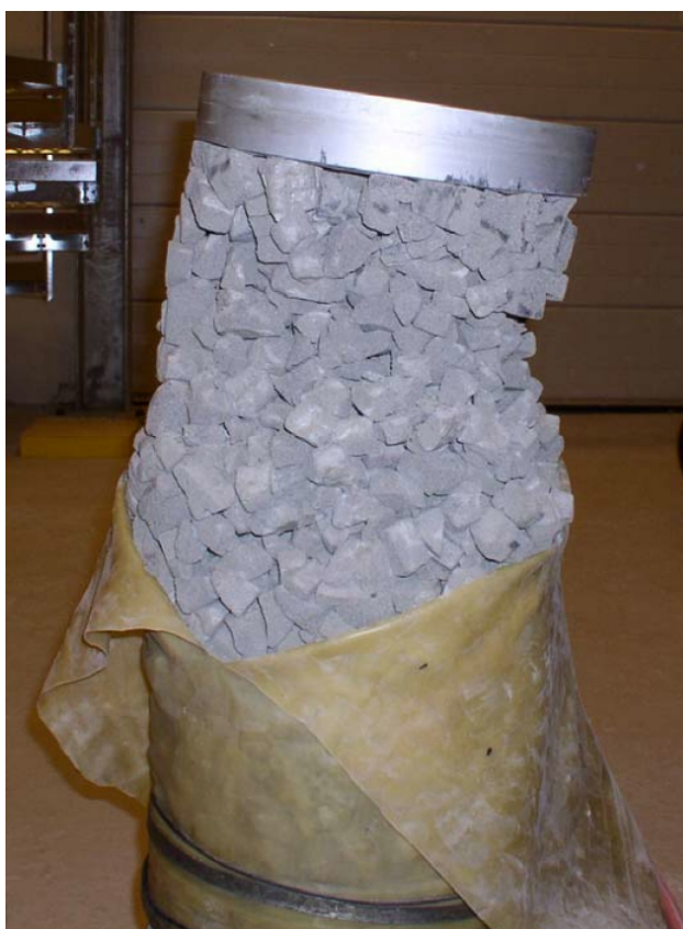
Kuva 18. HASOPOR-vahtolasimurskeen leikkauskestävyysskulman määrittäminen suurimittakaavaisella kolmiakksiaalikoekokeella (Aabøe et al. 2005 b)
