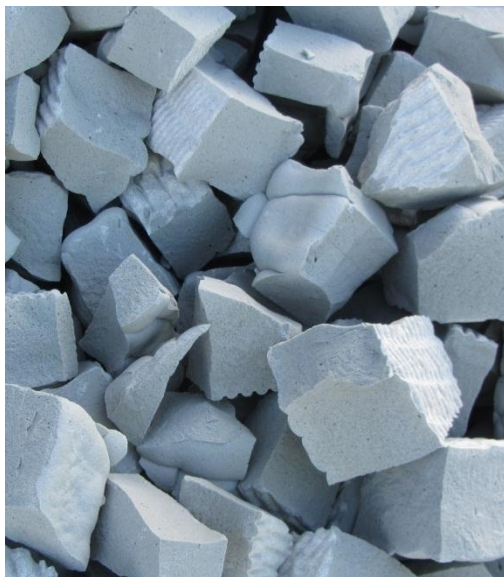
Kuva 17. Kulmikasta vaahtolasimursketta suoraan tuotantolinjalta (Emilia Köyljärvi 2013)
