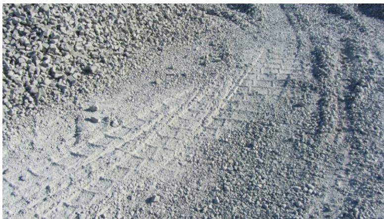
Kuva 23. Toistuvasti pyöräkuormaajalla yliajettua vaahtolasimursketta Uusio-aines Oy:n tehtaan varastoalueella 5.4.2013 (Emilia Köyljärvi 2013)
