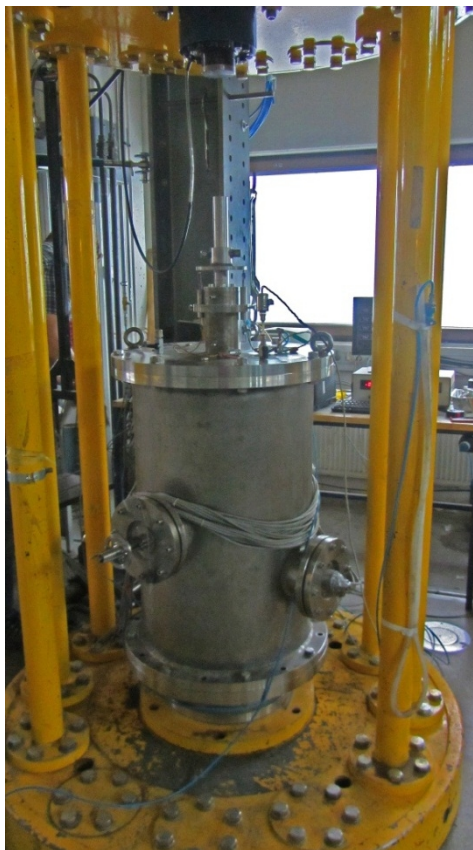
Kuva 30. Kolmiaksaalikoelaitteisto, näyteselli. Kuormitus ei vielä alkanut. (Emilia Köyljärvi 2013)
