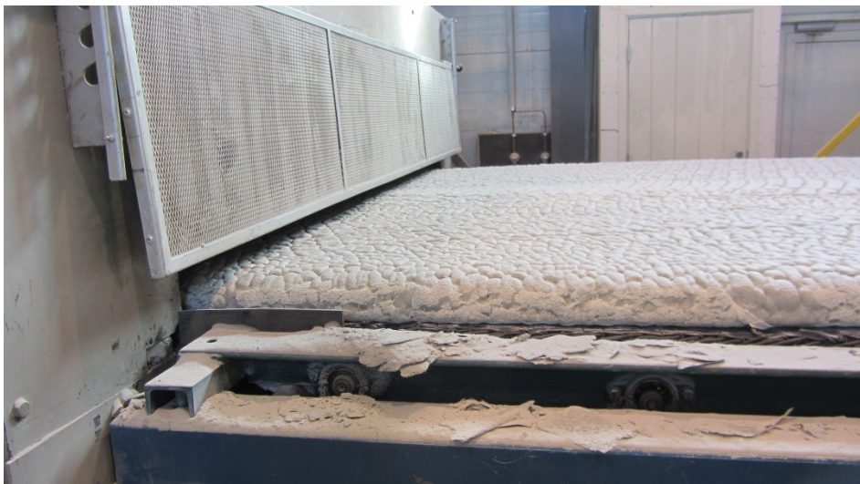
Kuva 2. Uunista tuleva vaahtolasilaatta Uusioaines Oy:n tehtaalla 5.4.2013 (Emilia Köylijärvi 2013)
