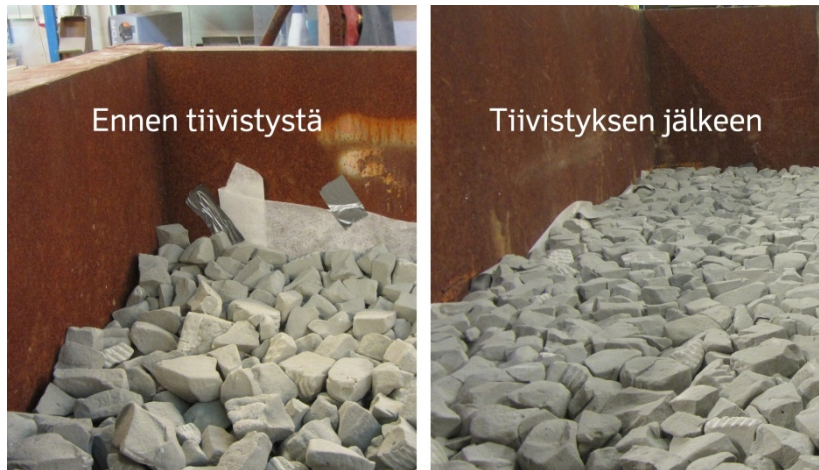
Kuva 35. Tiivistyskoe näytteen yläpinta ennen tiivistystä ja tiivistyksen jälkeen. (Emilia Köyljärvi 2013)
