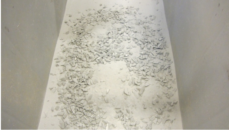
Kuva 40. Tiivistyskoe­näytteen ylimmän kerroksen alle 18 mm raekoon aines kokeen jälkeen. (Emilia Köylijärvi 2013)
