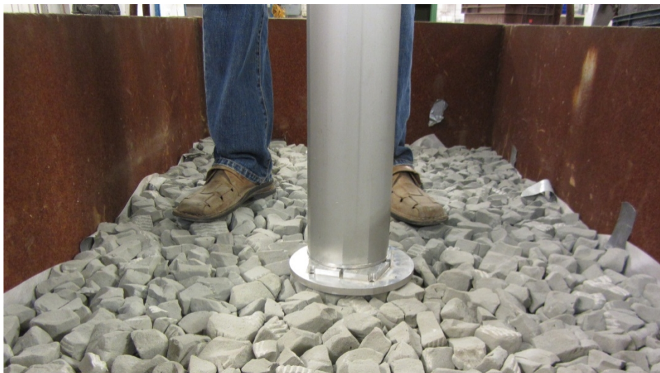
Kuva 29. Tiivistetyn vaahtolasimurskeen jäykkyyttä kuvaavan moduularvon mittaus käsikäyttöisellä Loadman-pudotuspainolaitteella (Emilia Köylijärvi 2013)
