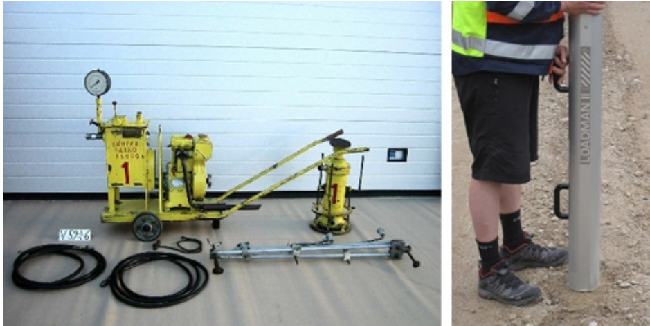
Kuva 3 Vasemmalla levykuormituslaitteisto (Museovirasto 2013) ja oikealla käsikäyttöinen pudotuspainolaite Loadman (Erkki Oksanen 2011)
