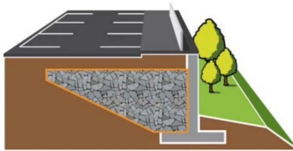
Kuva 11. Vaahtolasimurske tukimuurin kevyenä taustatäyttönä (Uusioaines 2012)
