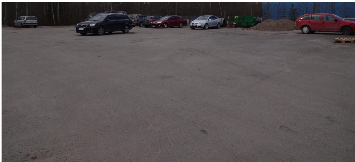
Kuva 47. Koekohteen 3 etualalla perinteistä asfalttibetonia ja taustalla bitumikaterouhetta sisältävää asfalttibetonia.
