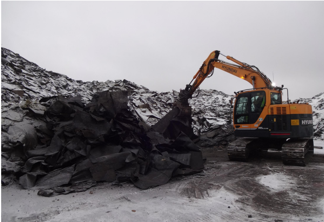
Kuva 4. Bitumikatejätteen koneellinen jälkilajittelu, jossa bitumikatekuormasta poistetaan syntypaikkalajittelussa joukkoon jääneet rakennusjätteet.
