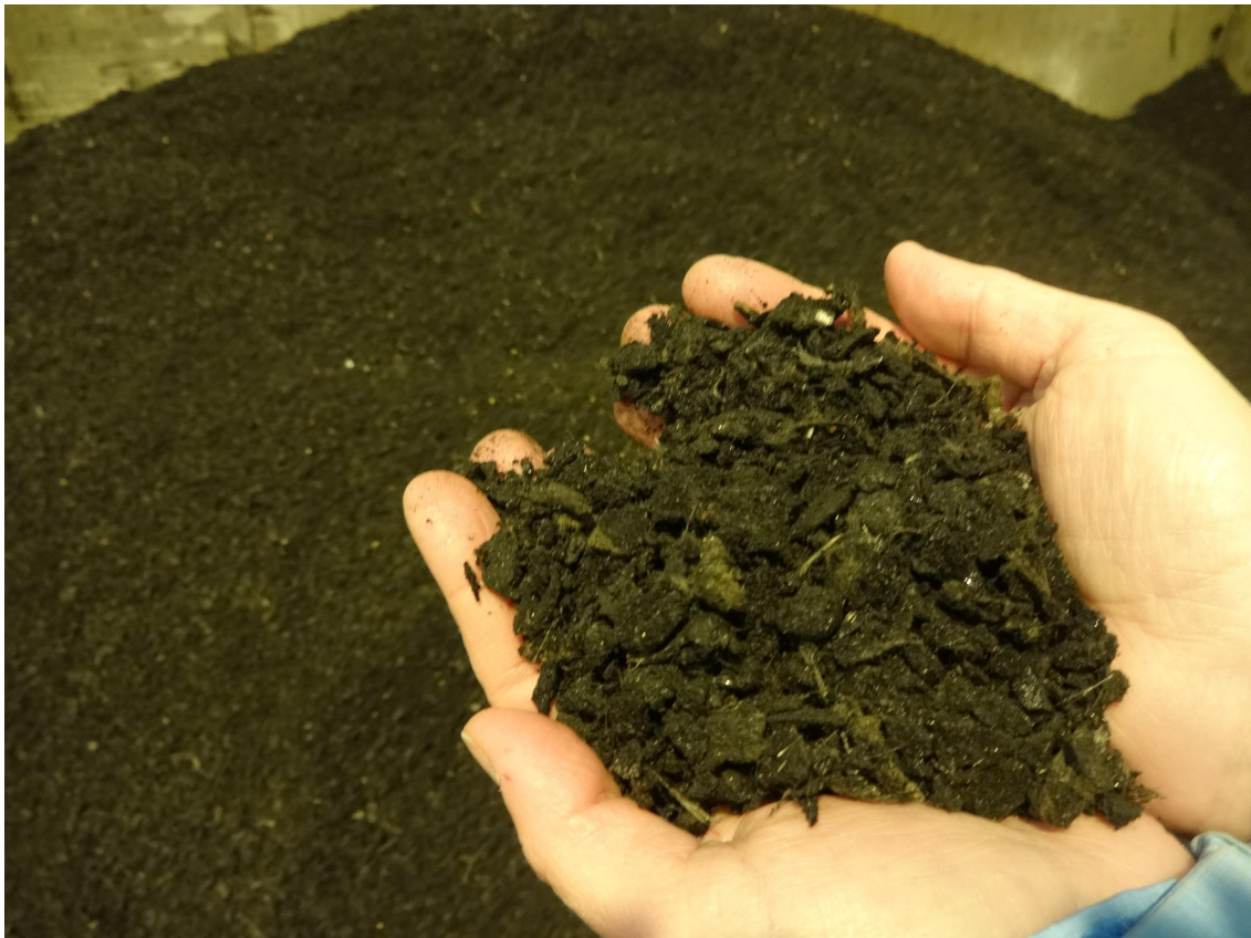
Kuva 5. Valmistaa 0–12 mm raekokoon murskattua bitumikaterouhetta.
