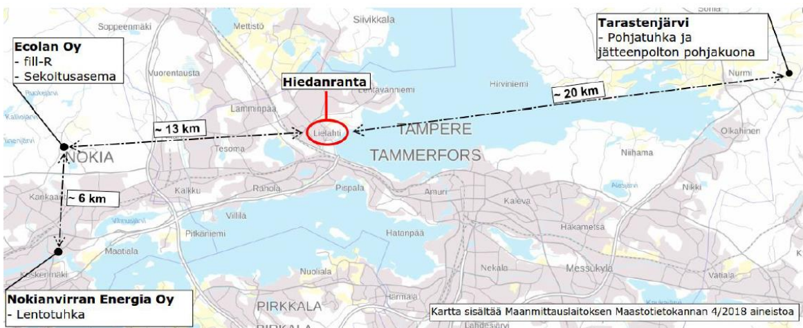
Kuva 6 Hiedanrannan koerakentamisessa käytettyjen uusiomateriaalien muodostumispaikat ja kuljetusetäisyydet sekoitusasemalle ja työmaalle (Harju, 2020).
