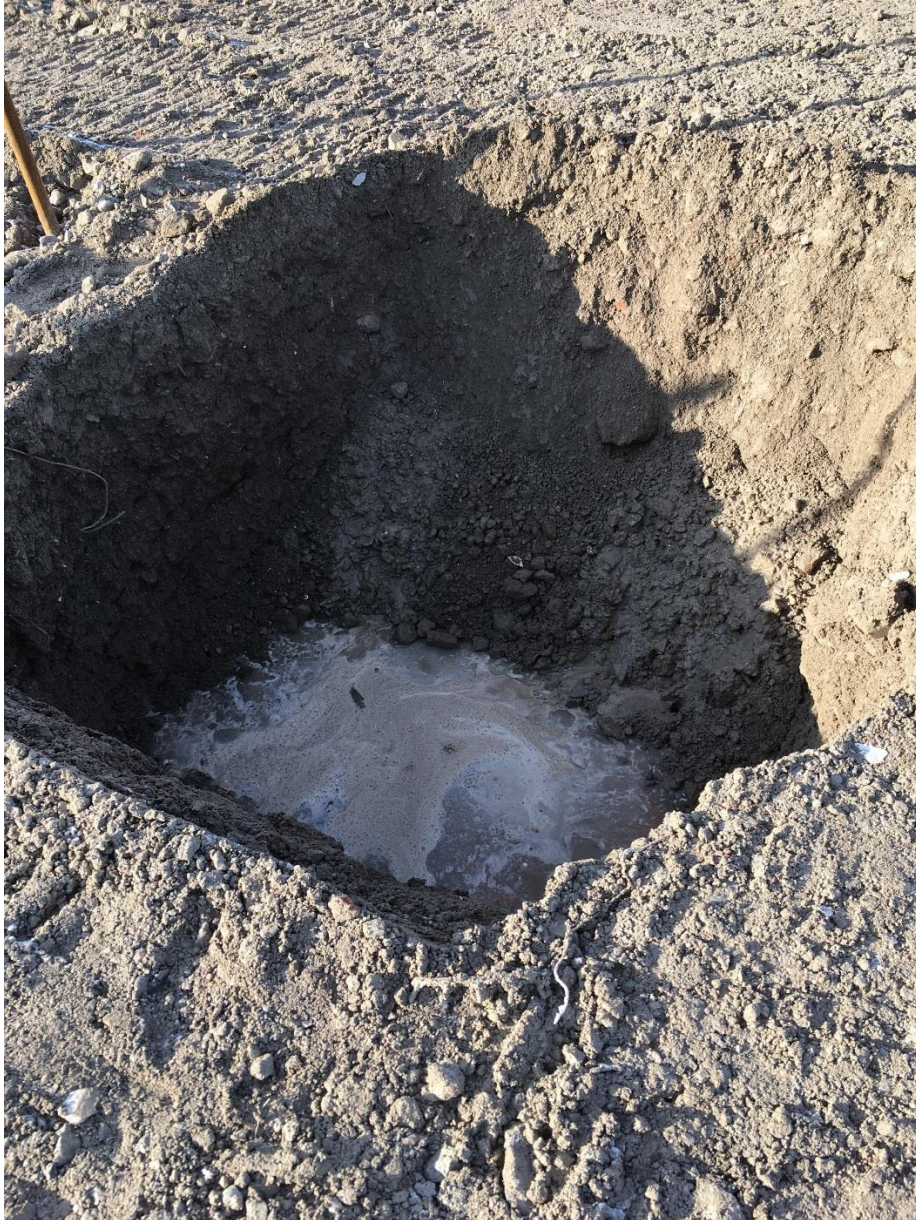
Kuva 29. Koekuoppa koealueella 1 (BeM #0/90) (Kuva: Anttila 20.3.2019).
