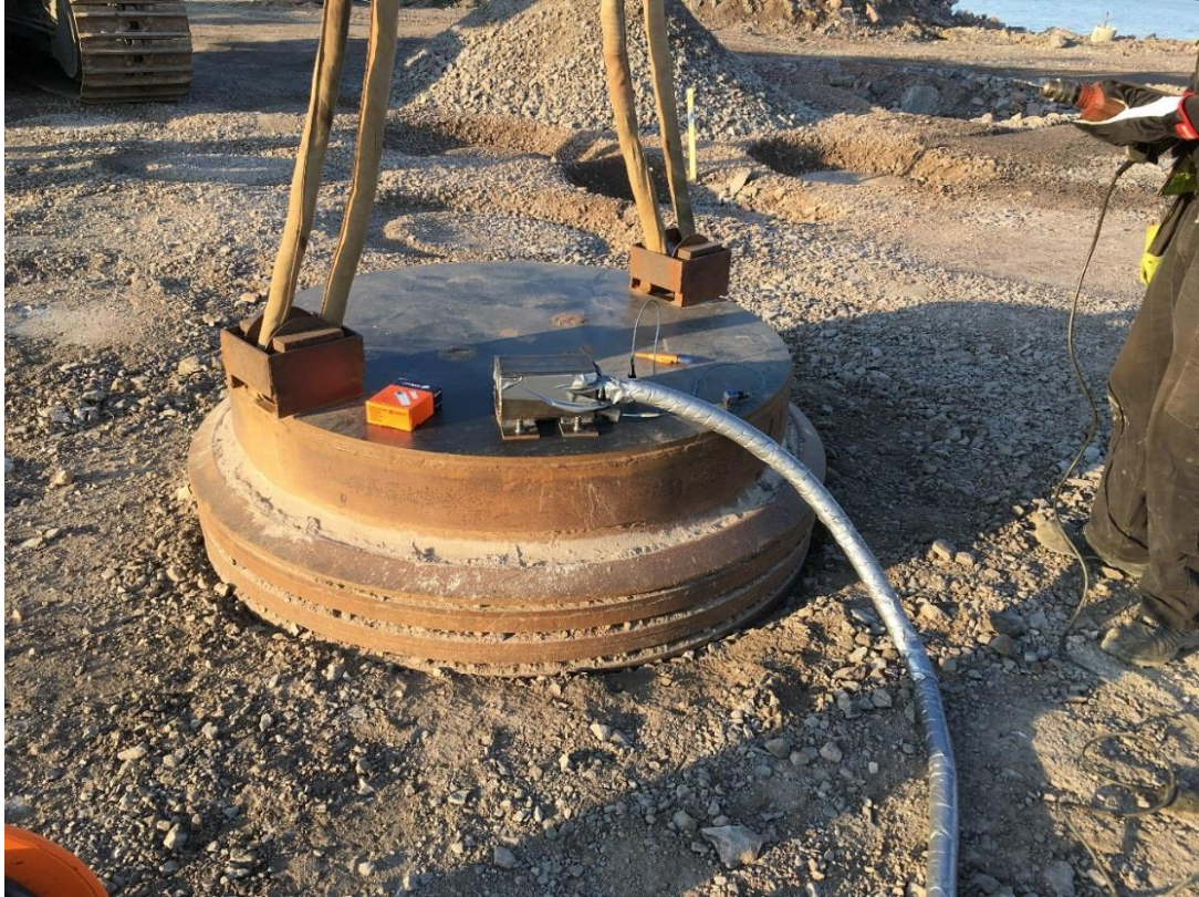
Kuva 25. Pudotusjärkele ja siihen kiinnitetty kiihtyvyyssanturi. Järkeleen päällä vasemmassa oleva oranssi rasia ei liity kiihtyvyyssanturiin (Kuva: Anttila 4.4.2019).
