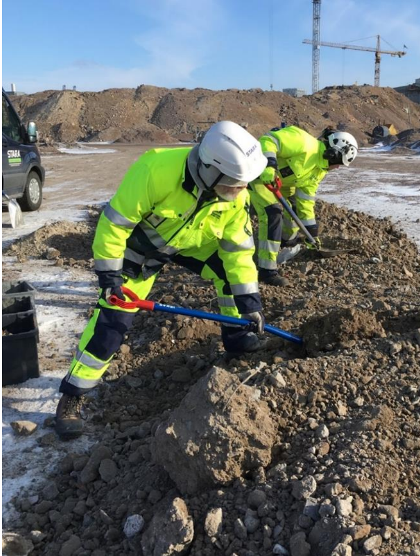
Kuva 27. Näytteenotto koerakenteen täytön yhteydessä alueelle kuljetetuista kuormista (Kuva: Anttila 12.3.2019).
