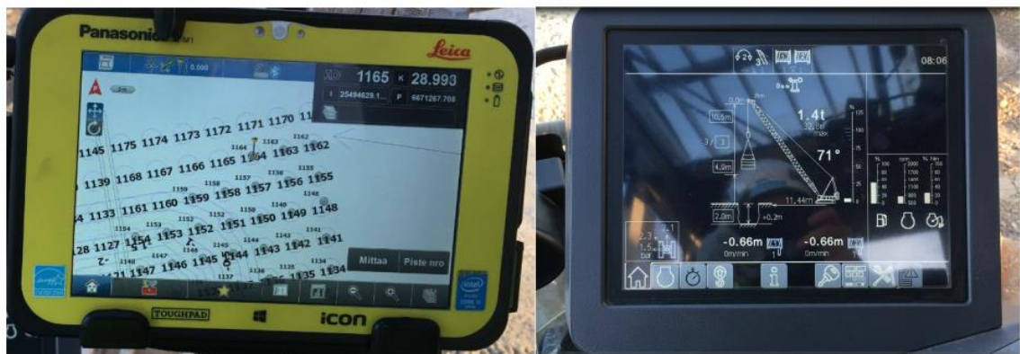
Kuva 11. Suunnitellut pudotuspisteiden sijainnit ja pudotuksen toteumatiedot nosturin ohjaamossa sijaitsevilla näytöillä (Kuva: Anttila 5.4.2019).
