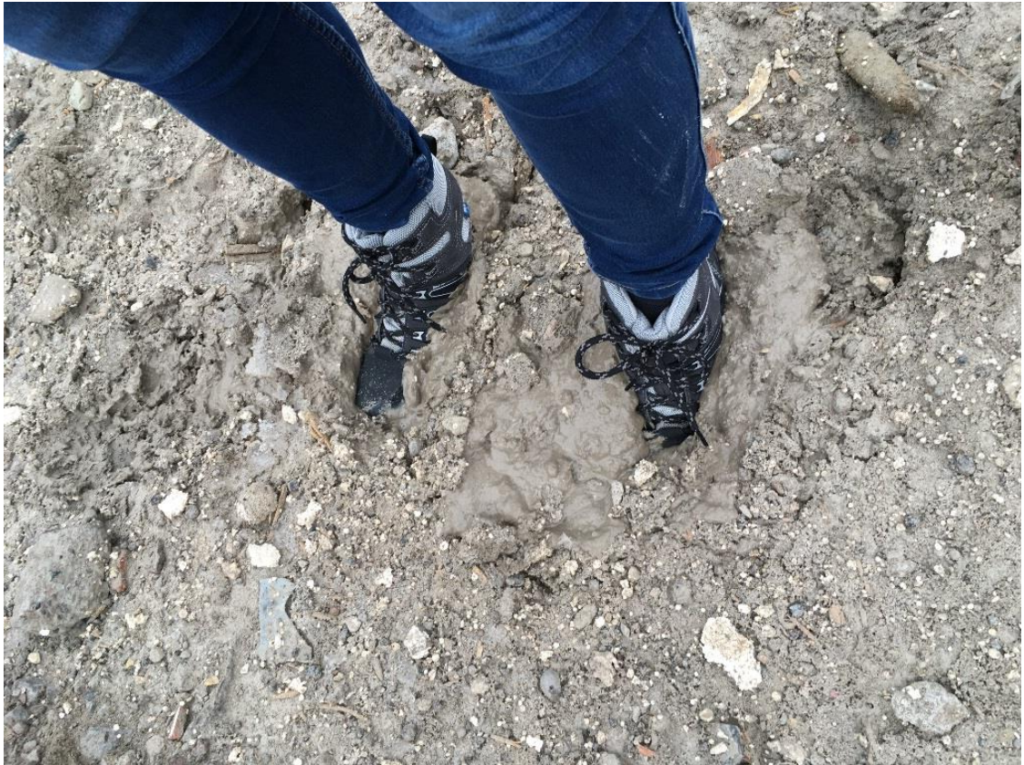
Kuva 19. Liettynttä betonimursketta # 0/90 tasolla +0,9...+1. (Kuva: 15.3.2019 Anttila 2019).
