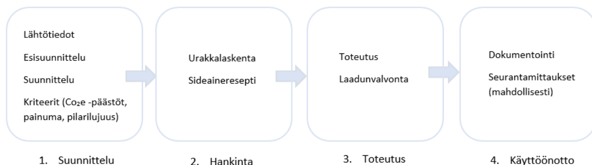
Kuva 11. Vaihtoehto 2 on syvästabiloinnin hankintamalli, jossa urakoitsija vastaa sideainereseptöinnistä (UUMA4 2022).
