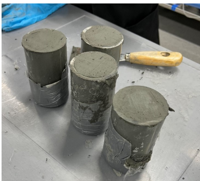
Kuva 15. Lujittumattomat koekappaleet sullottuna näyteputkiin (kuva Onerva Oksman 17.11.2021, Turku AMK).
