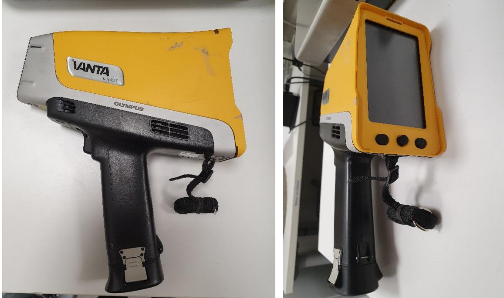
Kuva 2.15: Koepilareiden tutkimisessa käytetty Olympus – Vanta – XRF-laite. (valokuvat Tytti Nguyen 11.9.2020)
