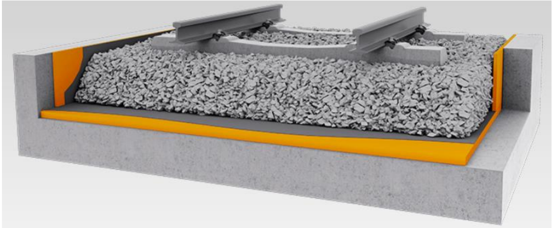
Kuva 2.5 Tukikerroksen alusmatto (Getzner 2017b).
