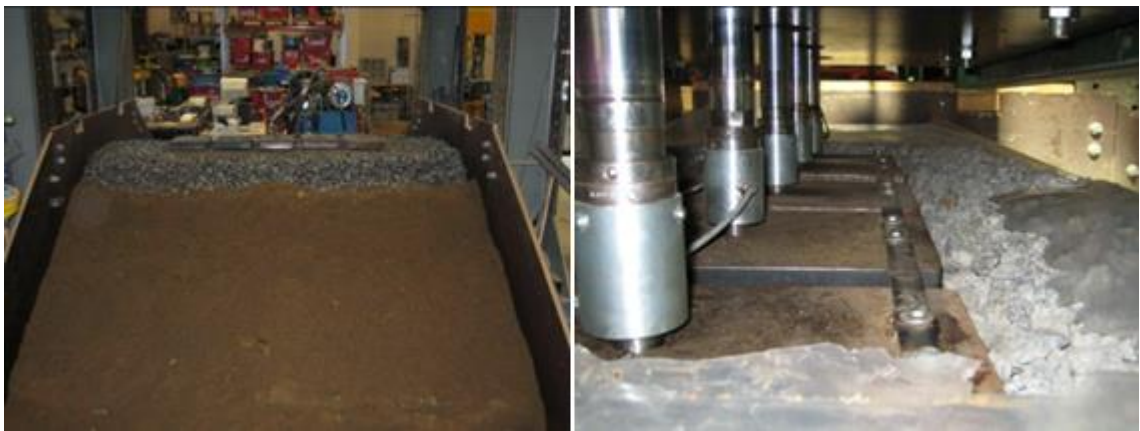
Kuva 5.11 TTY:n peräkkäisten kuormitustunkkien koejärjestely (Kalliainen & Kolisoja 2013).
