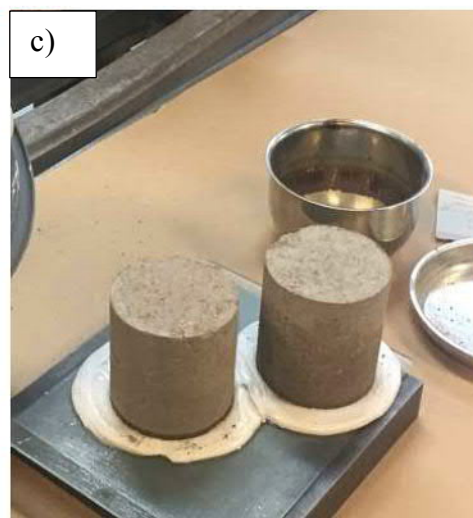
Kuva 14. Zwick & Roell puristuslaite (a) sekä koekappaleiden päiden tasoitus kipsilaastilla ennen purituslujuuden määrittämistä (b) ja (c) (valokuvat Kortelainen 2018).
