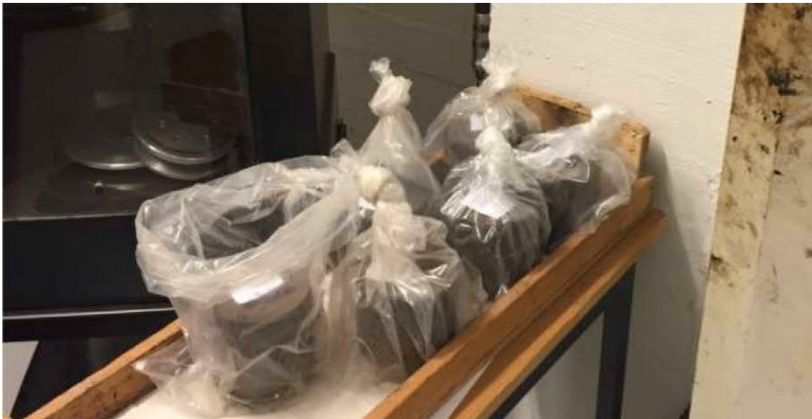
Kuva 13. Koekappaleet säilytettiin muovipusseissa huoneenlämmössä (valokuva Kortelainen 2019).
