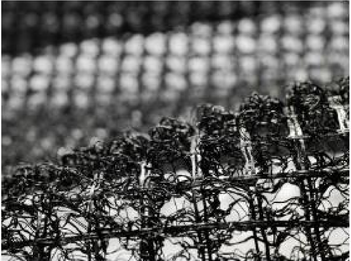
Kuva 27. Salaojamaton vettäjohtava ydin, geomesh (Meltex Oy Plastics)
