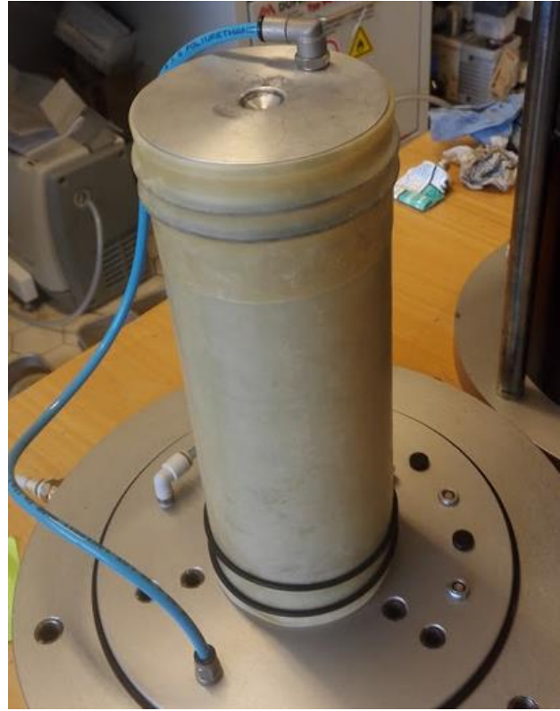
Kuva 16. Koetta varten valmistettu koekappale ennen sellin sulkemista.
