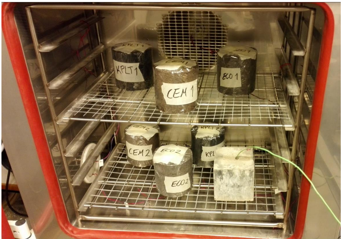
Kuva 14. Koekappaleet jäädytys-sulatuskaapissa ennen kokeen aloitusta. Alahyllyllä on oikeassa reunassa betonikappale, johon on istutettu sisälle lämpötila-anturi.
