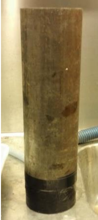
Kuva 11. Näytteeseen kiinnitetty teräsputki.
