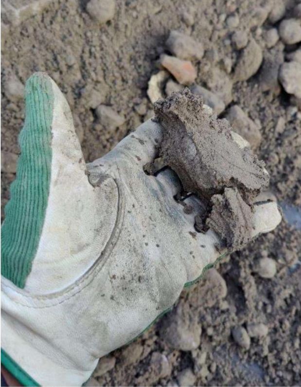
Kuva 7.4. Massasta käsin puristettu kappale massan koostumuksen ja vesipitoisuuden arvioimiseksi. (19.10.2021)
