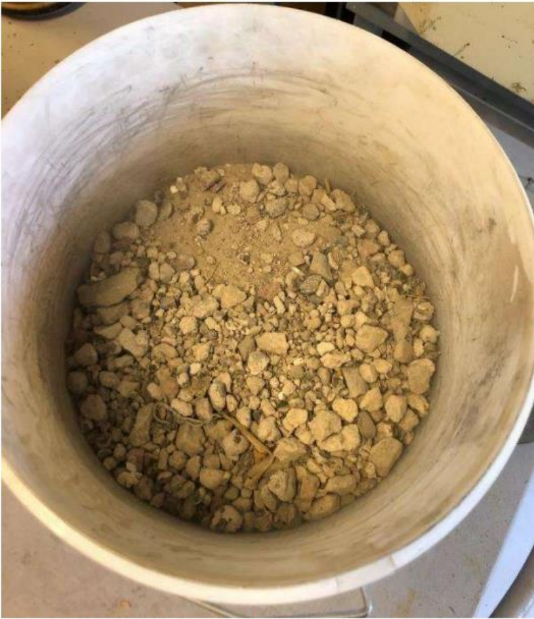
Kuva 3.2. Laboratoriokokeissa 16 mm raekokoon seulottu ja uunissa kuivattu III-luokan betonimurske. (11.6.2021)
