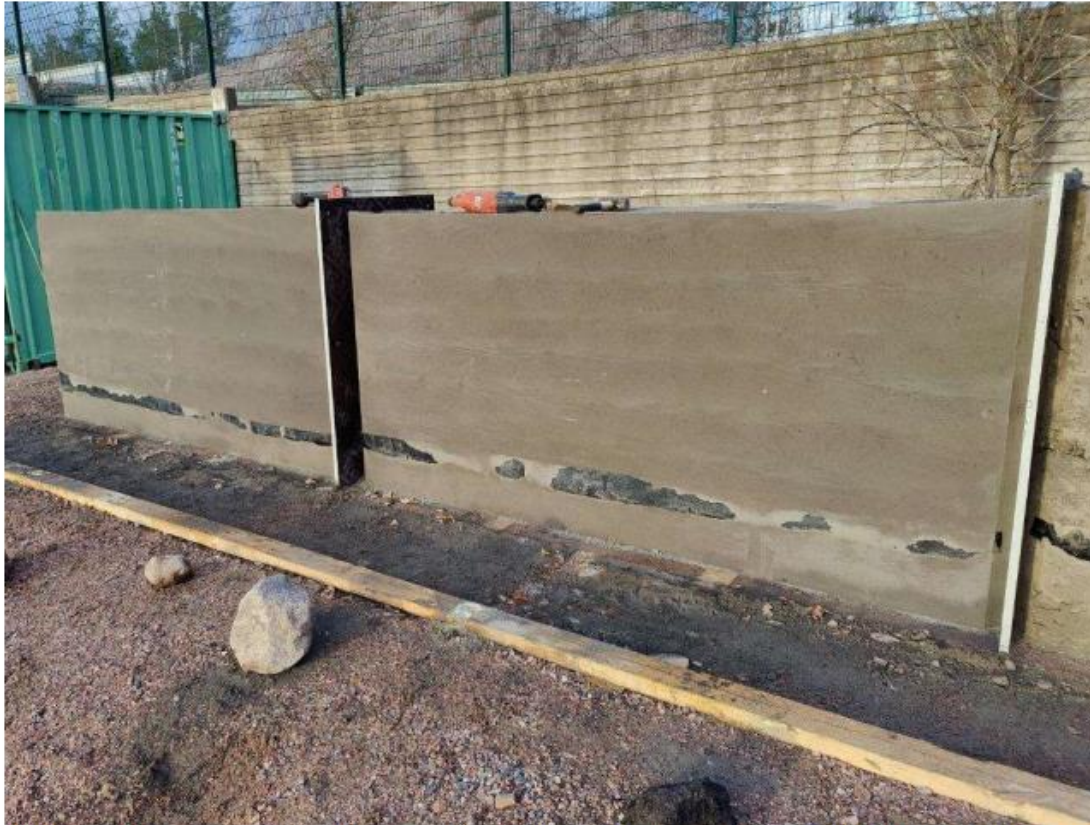
Kuva 7.10. Koerakenteen koeosuudet 4 ja 3 (JpKu+LT HELEN (1:5) ja JpKu+LT HELEN (1:4)) muotin purkamisen jälkeen. (12.11.2021)
