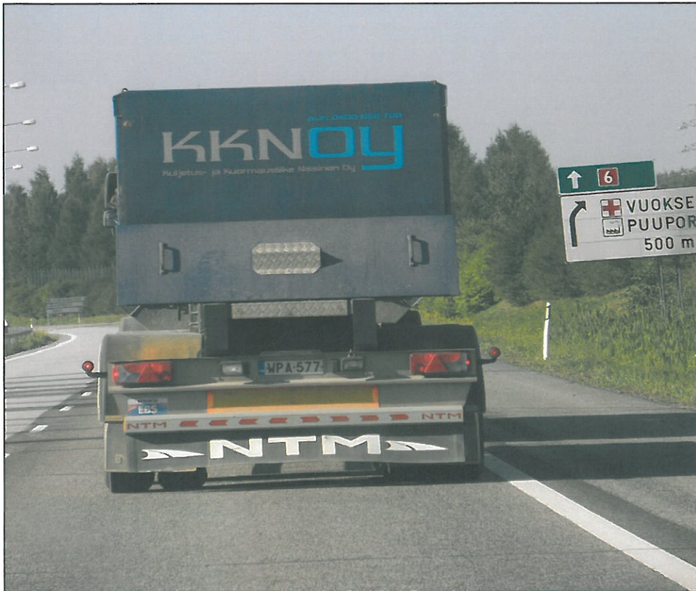
Kuva 3. Tuhkakuorman ajo kaatopaikalta rakentamisen kohteeseen. Pölyämistä ei tapahtunut.
