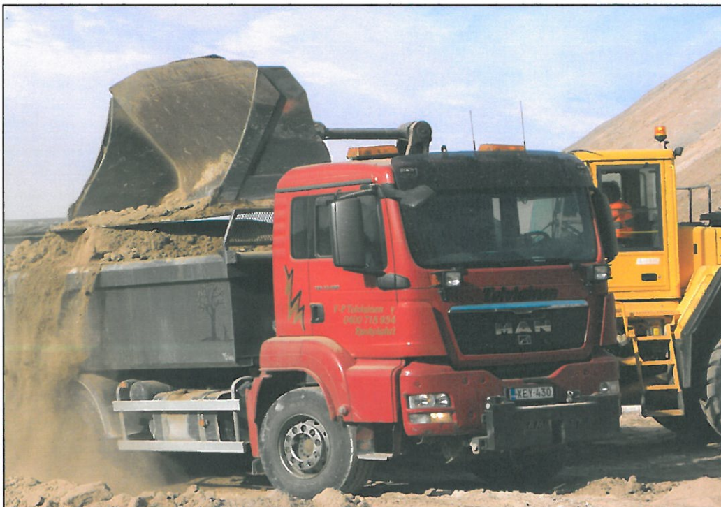
Kuva 6. Tuhkan lastausta ison kauhakuormaajan avulla. Lastausvaiheessa kaatopaikalla tapahtui tuhkan pölyämistä.
