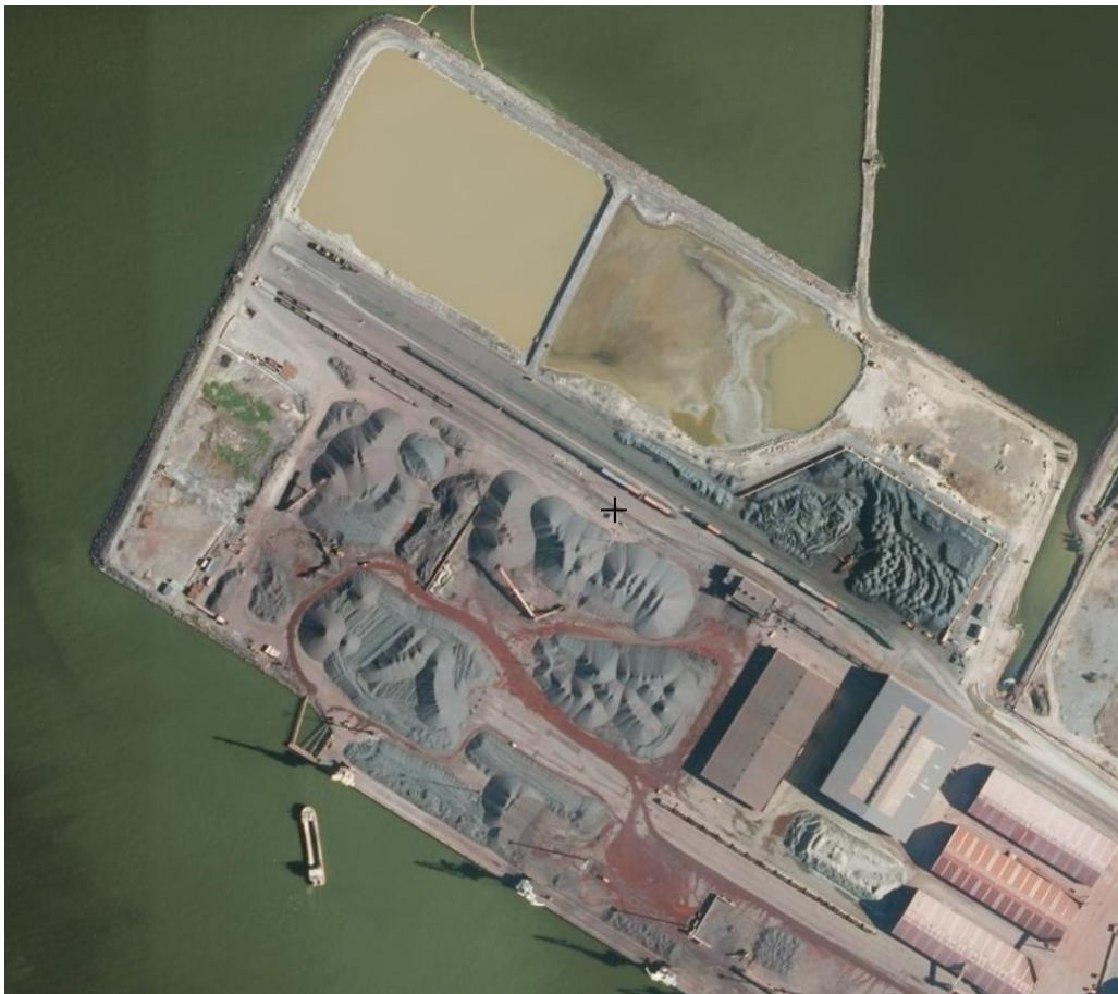
Syväsataman täyttöalueen täytön eteneminen. Kuvaushetki kesäkuu 2019. Altaan A täyttäminen imuruopatuilla massoilla on juuri päättynyt.
