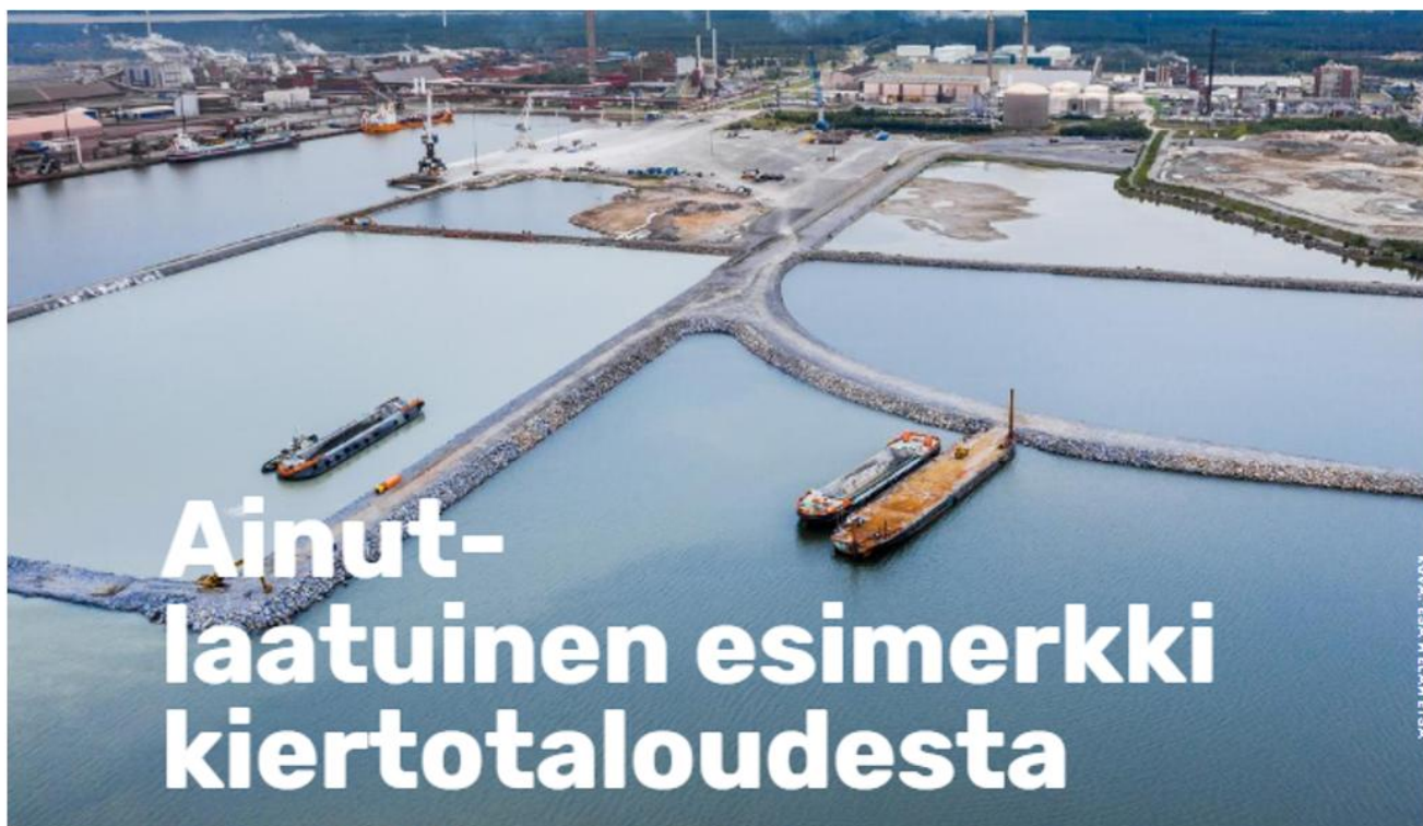
Syväsataman täyttöalueen täytön eteneminen. Kuvaushetki kesäkuu 2019. Altaan A täyttäminen imuruopatuilla massoilla on juuri päättynyt.
