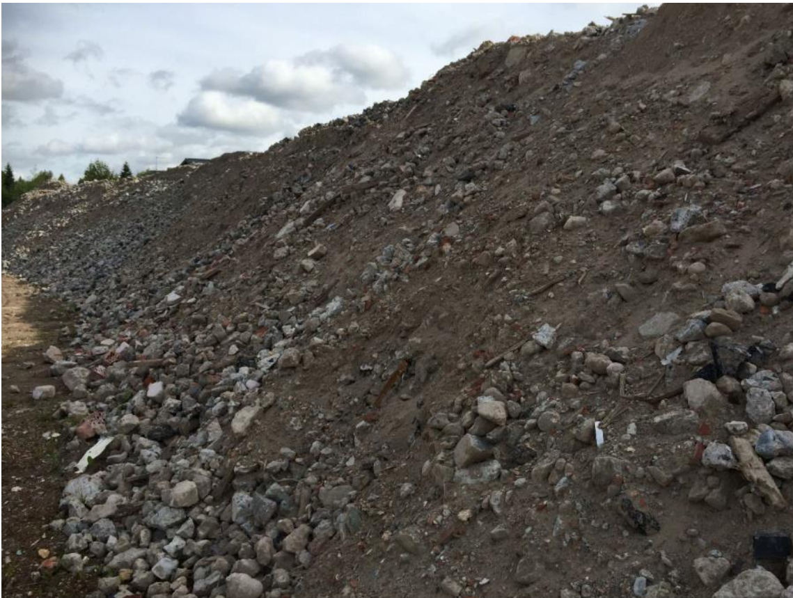
Kuva 4. Valmista betonimurskettä aumoihin varastoituna.
