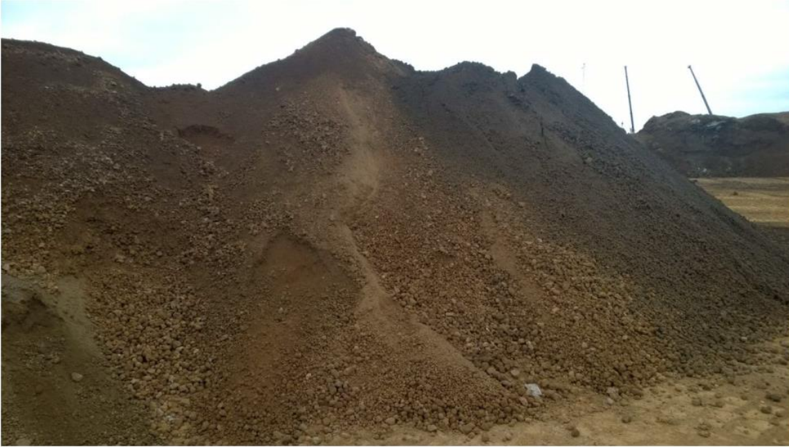
Kuva 2. Valmista rakeistettua tuhkaa kasassa varastoituna. Taustalla näkyy raaka-ainekasa, josta rakeistettua tuhkaa valmistetaan.
