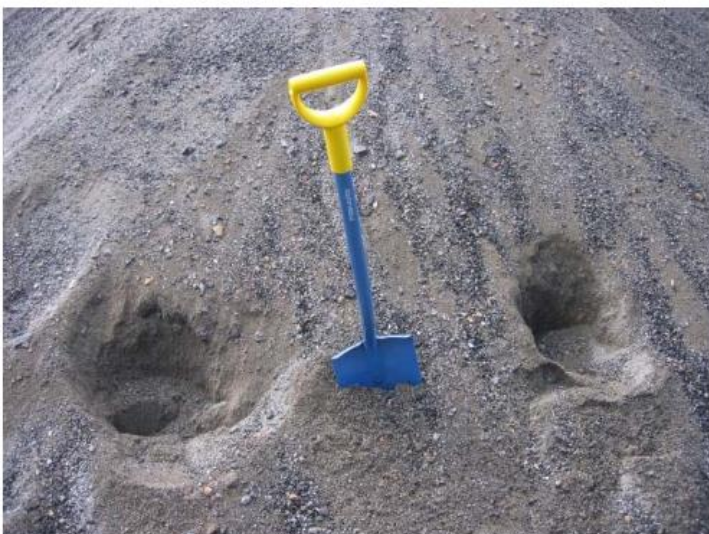
Kuva 4.3. Suomenojan leijupetituhkaa varastoituna voimalaitoksen pihalle.
