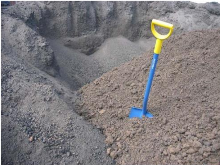
Kuva 4.2. Suomenojan hiilipölytuhkaa varastoituna voimalan pihalle. Vasemman kasan tuhka on vanhaa ja oikealla edellisessä päivänä varastokasalle tuotua ja kosteampaa.
