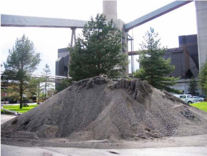
Kuva 4.5. Suomenojan leijupetituhka varastoituna avokasaan voimalan pihalle.
