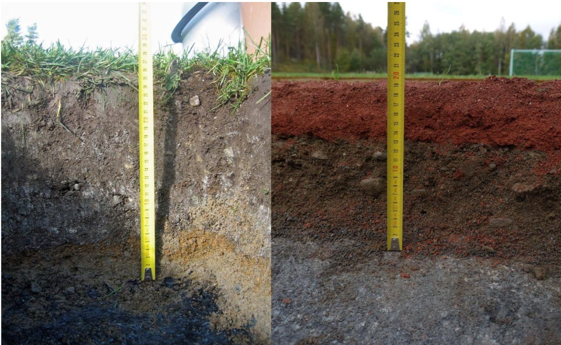
Kuva 4. Kuitutuhkan päällä olevat rakennekerrokset (25.9.2013)
